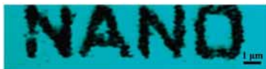
圖 2-23 K. Wada 等人以 CdSe 奈米顆粒鋪成的 NANO 字樣[65]
