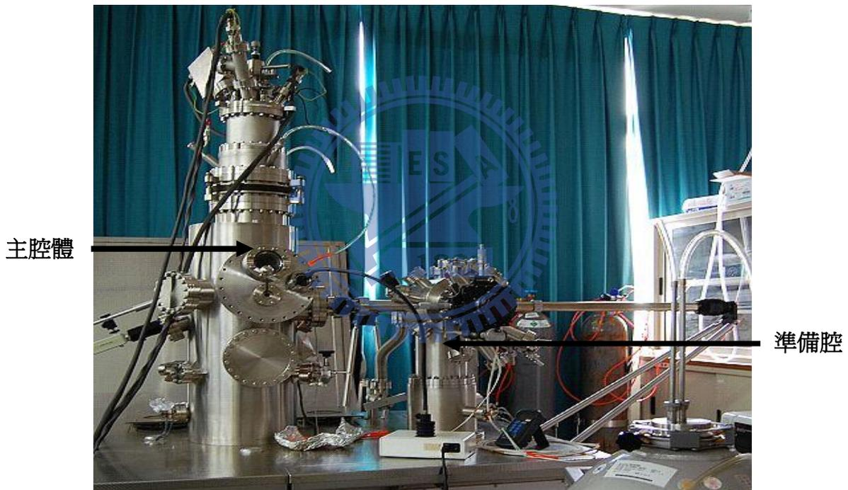
圖 3.1 Omicron 公司所製造的 UHV LT-STM。
