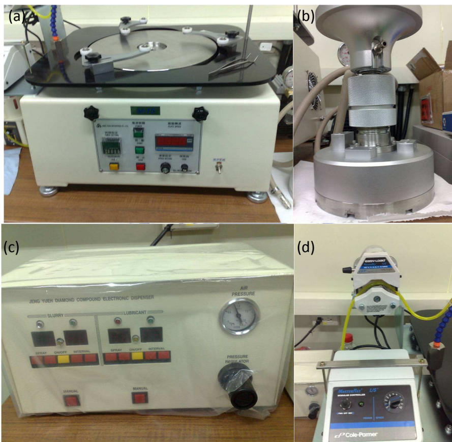
圖 3-5(a)研磨拋光機主機台(b)真空治具 (c)噴灑控制器(d)拋光液控制系統
