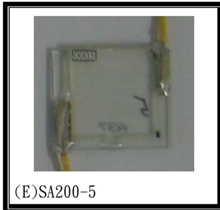
圖 4.1 五個不一樣厚度的液晶波板, (A)LC5-2, (B)SA040-2, (C)SA040-4, (D)SA200-1, (E)SA200-5
