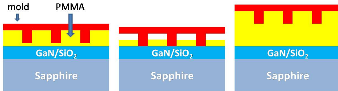
圖3.5 PMMA厚度對壓印製程影響示意圖。(a)壓印後最適PMMA厚度:約略多出模具突出高度一些。(b)過薄的PMMA厚度:容易使模具直接接觸到樣品/基板,造成兩者的破壞。(c)過厚的PMMA厚度:殘留層過多,需要較長時間的 O_2 Plasma,易破壞圖形的精準度。
