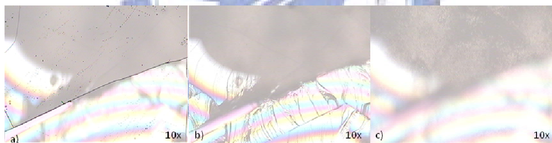
圖 4-1-2. 直接成長之 Nomarski(10x)圖。a)聚焦點在表面、b)聚焦點在中間、c)聚焦點在內部。
