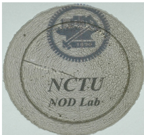
圖 5-1. 第一次再成長 1.2 吋整片氮化鎳基板(中心厚度 480um)
