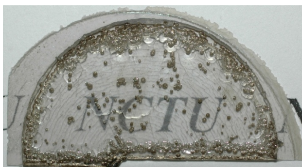
圖 5-3. 第一次再成長 1.2 吋半片氮化鎳基板(中心總厚度 705um)
