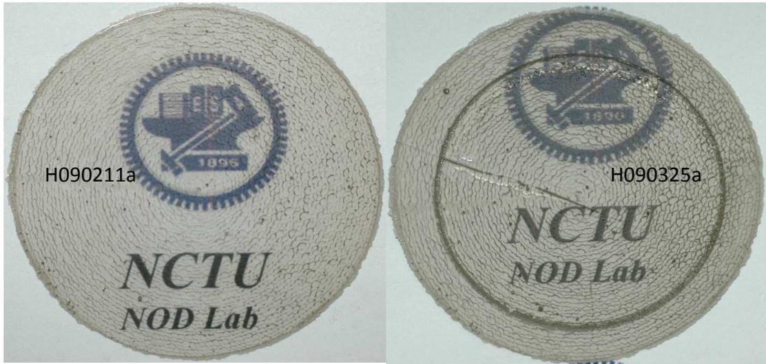
FIG4. 57 HVPE 再成長前後樣品實照-升溫過程產生裂痕
