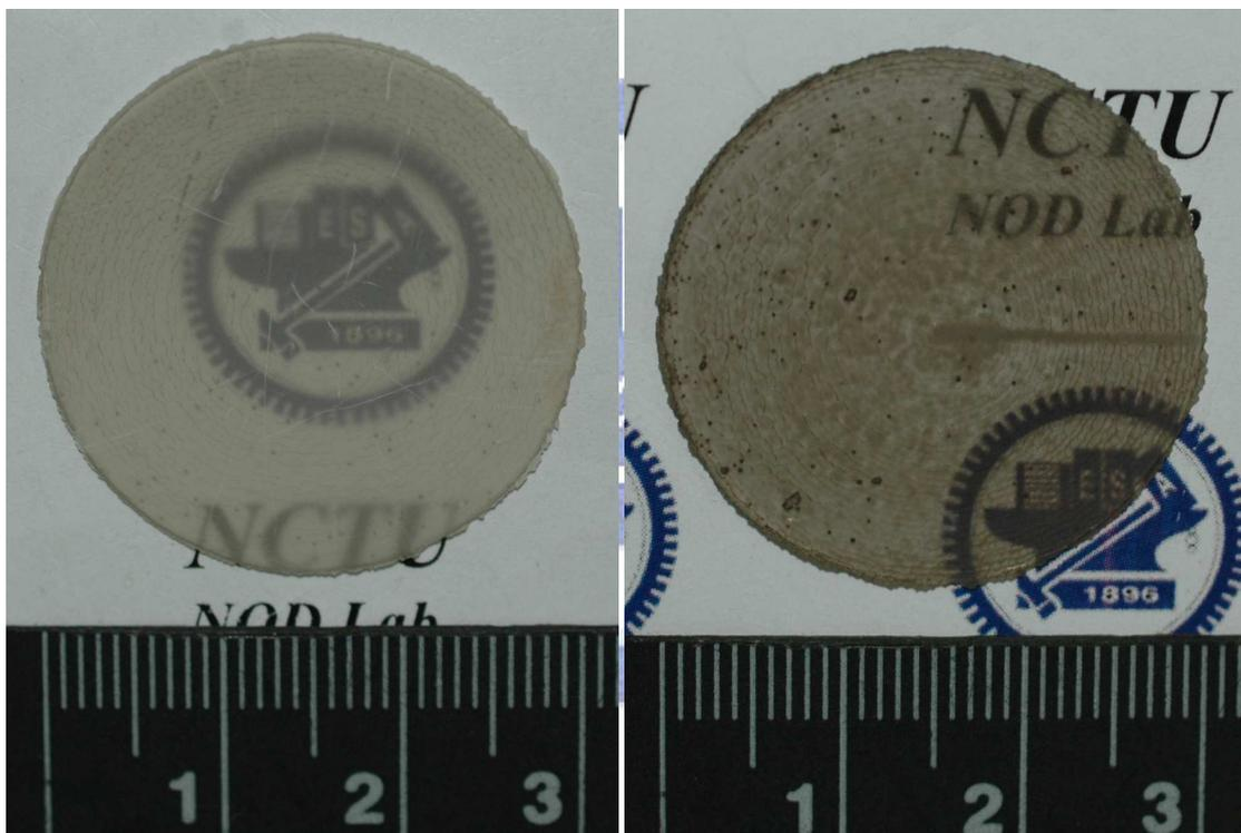
FIG4.53 經 ICP/RIE 蝕刻後之氮化鎵厚膜實照(左邊為 ICP;右邊為 RIE)
