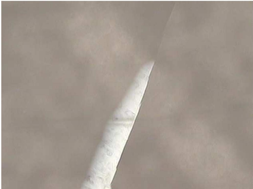
FIG4. 62 Regrowth 後 normaski 光學顯微鏡圖(對中間聚焦~成長中 crack)
