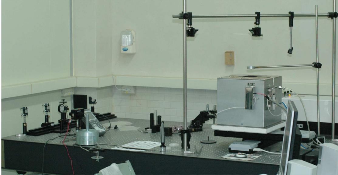
FIG3.7 雷射剝離系統光路實照
