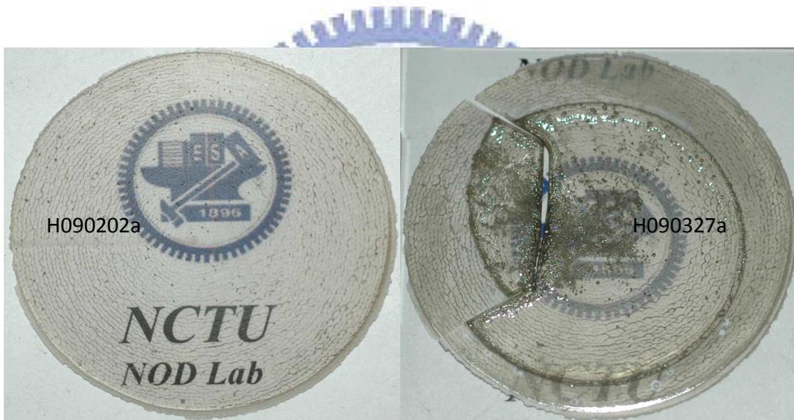
FIG4. 58 HVPE 再成長前後樣品實照-升溫過程即迸裂
