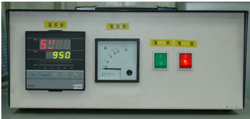
FIG3.12 加熱爐溫控器
