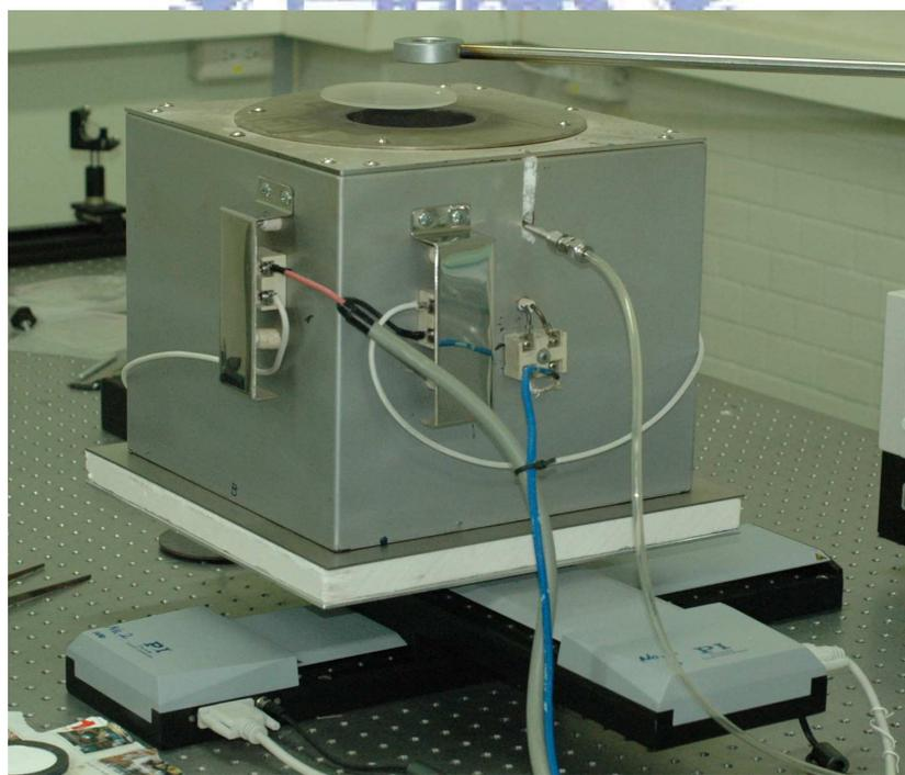
FIG3.9 移動平台與加熱爐
