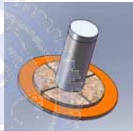
圖 4-5 壓電材料上連接上陶瓷管延伸管與樣品座
