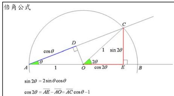
圖 5-2-7-16：由直角 $\triangle ACE$ 得 $\overline{AC} \cos \theta - 1$ 。
