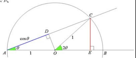
圖 5-2-7-8：做  $\overline{CE} \perp \overline{AB}$  於  $E$ 。
