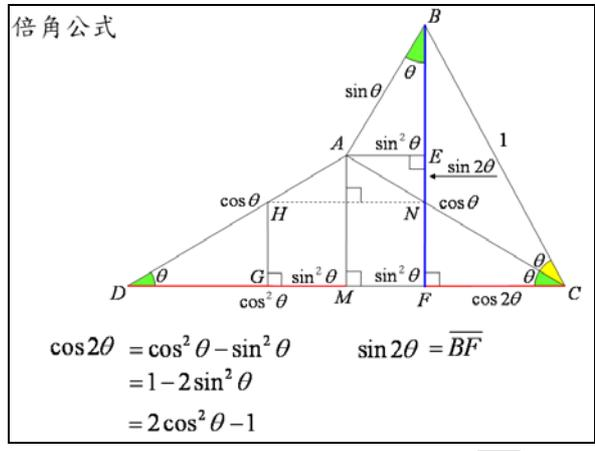
圖 5-2-6-30：由直角  $\triangle BCF$  得  $\sin 2\theta = \overline{BF}$ 。
