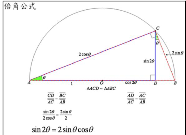
圖 5-2-2-18：再得  $\frac{\overline{AD}}{\overline{AC}} = \frac{\overline{AC}}{\overline{AB}}$ 。
