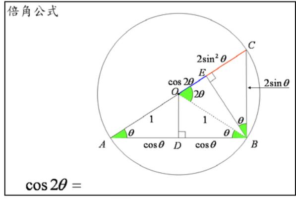
圖 5-2-4-12：標示  $\overline{CE}$ ，並由直角  $\triangle BCE$  得  $\overline{CE} = 2\sin^2 \theta$ 。
