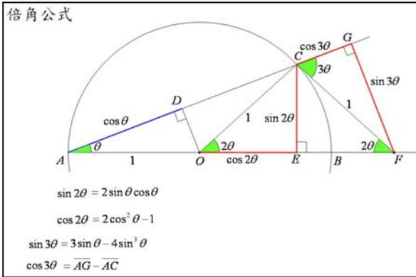
圖 5-2-7-29：顯示  $\cos 3\theta = \overline{AG} - \overline{AC}$ 。
