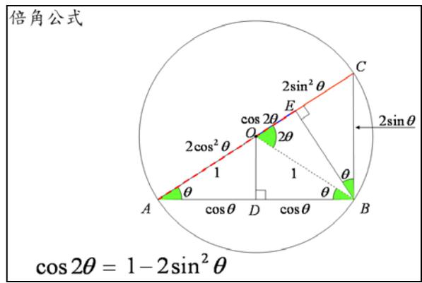
圖 5-2-4-14：標示  $\overline{AE}$ ，並由直角  $\triangle ABE$  得  $\overline{AE} = 2\cos^2 \theta$ 。
