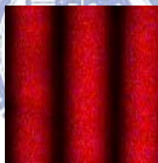
(b)加電壓 30V_{rms} 於 T-PNLC，干涉條紋向右
