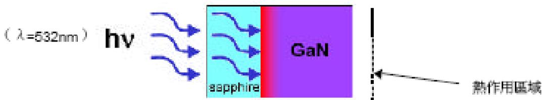
圖5-7 長波長雷射剝離過程氮化鎵緩衝層/藍寶石之界面之溫度分佈模擬
