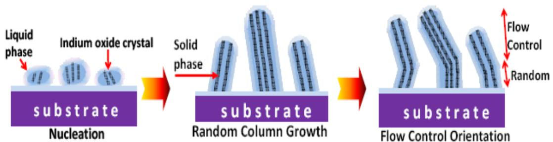
圖3-9 Catalyst-free VLS成長機制，主要包含有三個步驟，凝核階段的成長 (Nucleation)、柱狀結構成長階段(Random Column Formation)、氣流控制成長階段 (Flow Control Orientation)。
