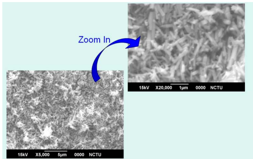
圖 3.1 \text{Co}_x\text{Zn}_{(1-x)}\text{O}_{(x=0.002)} 之 SEM 圖。
