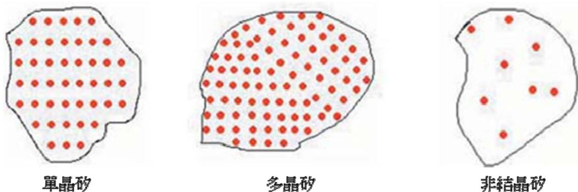
圖 1-3 不同材質矽晶太陽能電池的矽原子排列情形<sup>5</sup>。
