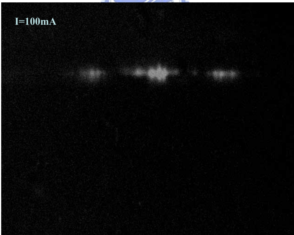
圖 4-19(a) 於光子晶體波導量得之光子晶體雷射近場發光圖形 @ I=100mA 光強度 400 倍衰減
