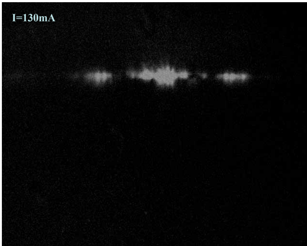
圖 4-19(b) 於光子晶體波導量得之光子晶體雷射近場發光圖形 @ I=130mA 光強度 400 倍衰減
