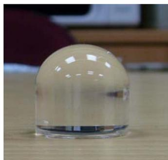
圖 4.15 以 PDMS 製作出的半球形凸透鏡：(a) 斜上方俯瞰圖；(b) 側視圖。
