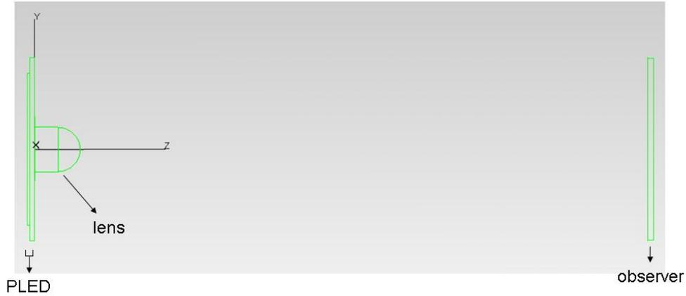
圖 4.12 PLED 光源加上 lens 後的示意圖。
