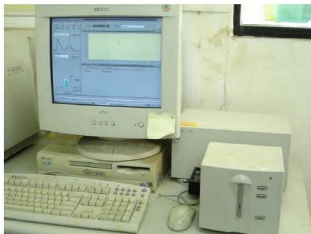
圖 3.18 UV-Visible 光譜實際量測系統。
