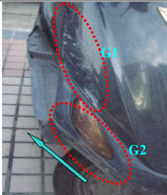
A 車右前護板受損情形
