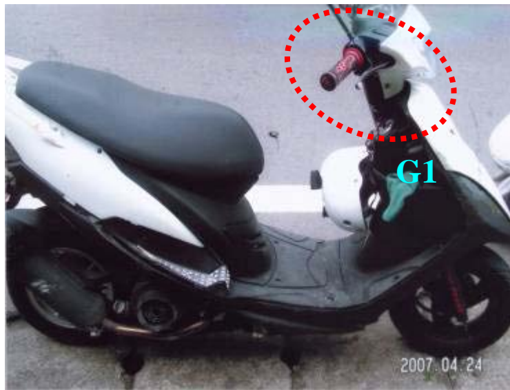
A 車右側車身受損情形
