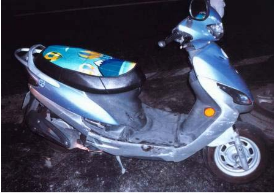
A 車車身受損情形
