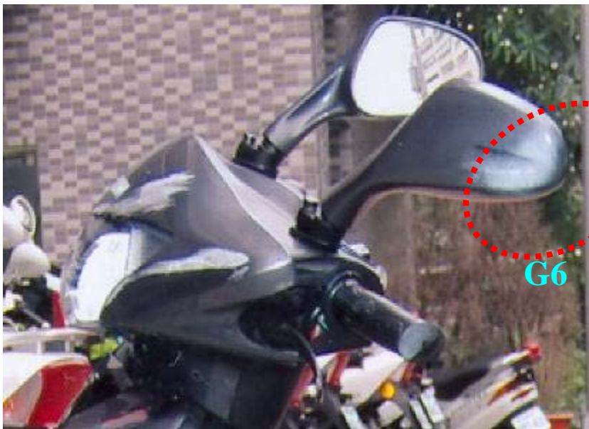
A 車左後視鏡受損情形
