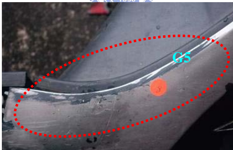
A 車右前護板受損情形
