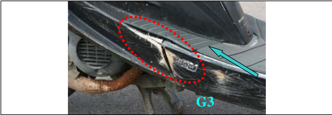
照片 5.2-5e 右側車身擦地痕情形(實驗 5)
