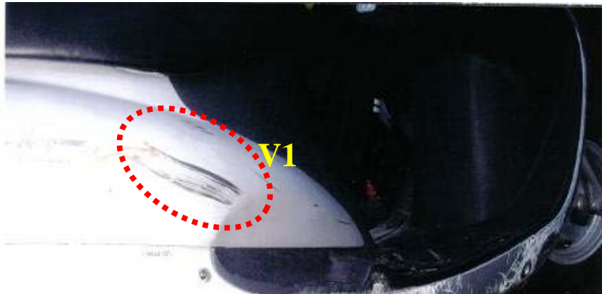
A 車右側護板與右後車身受損情形
