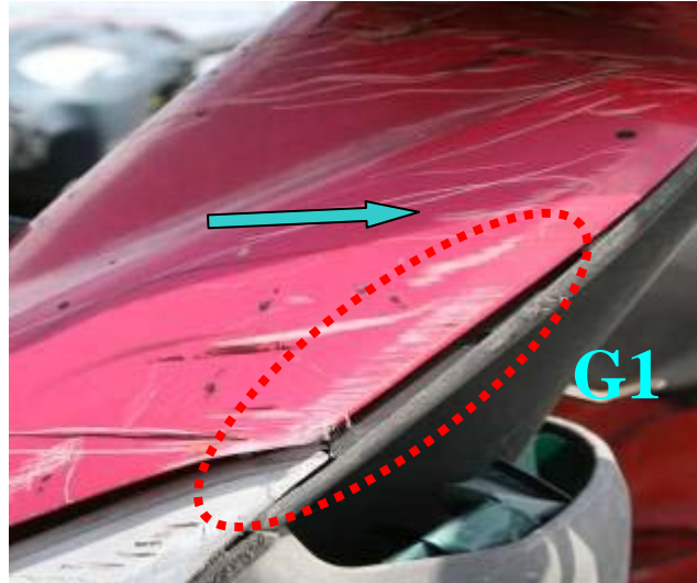
照片 5.2-25c 左前車頭擦地痕情形(實驗 25)
