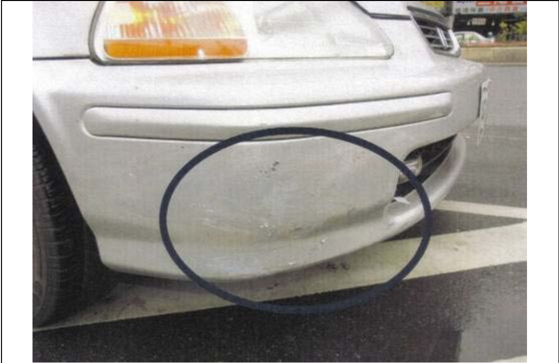
B 車右前外殼受損情形
