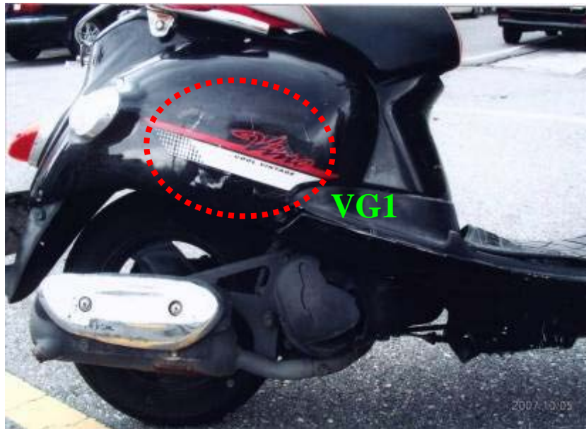
B 車右後側車身受損情形
