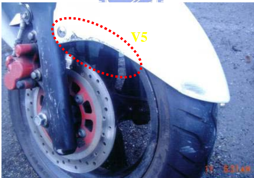
A 車右前檔泥版受損情形
