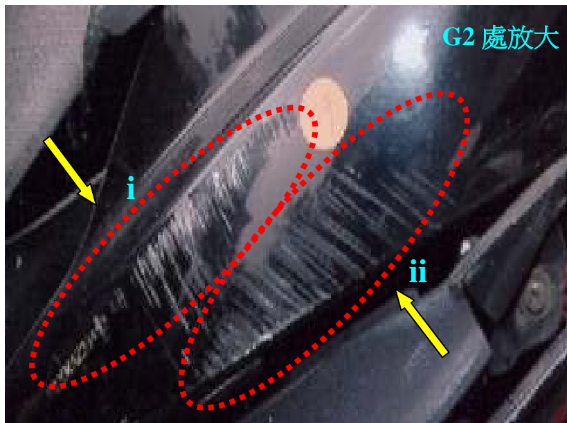
B 車左前護板刮損情形
