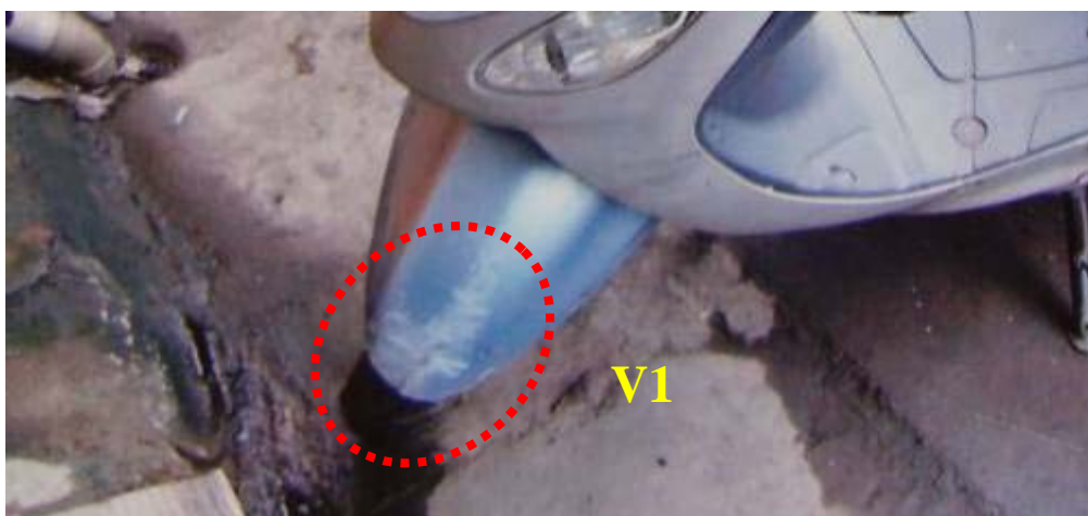
A 車前車輪擋泥板護蓋受損情形
