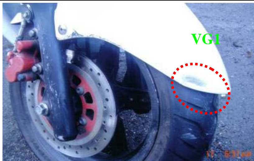
A 車右前檔泥版受損情形
