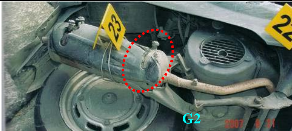
A 車右側排氣管護蓋受損情形
