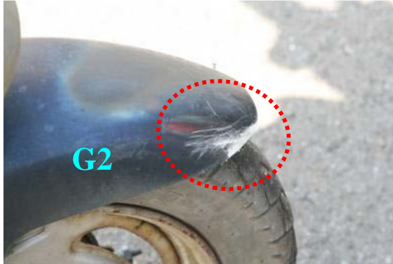
照片 5.2-24d 右前車頭擦地痕情形(實驗 24)
