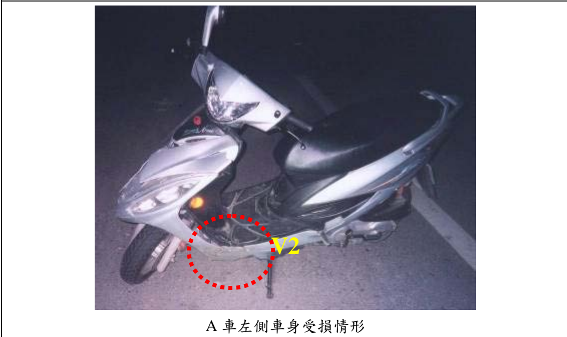
照片 4.3-14 b 資料照片翻拍 A 車車身油漆刮痕 (案例十四)
