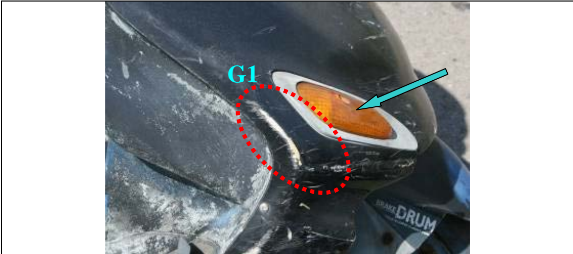
照片 5.2-9c 右前車頭擦地痕情形(實驗 9)
