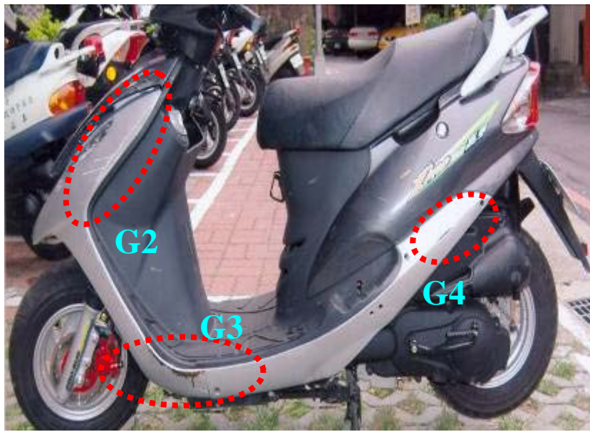
A 車左側車身受損情形
