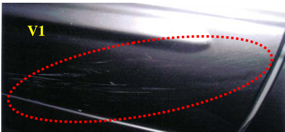
B 車右後車門處受損情況情形
