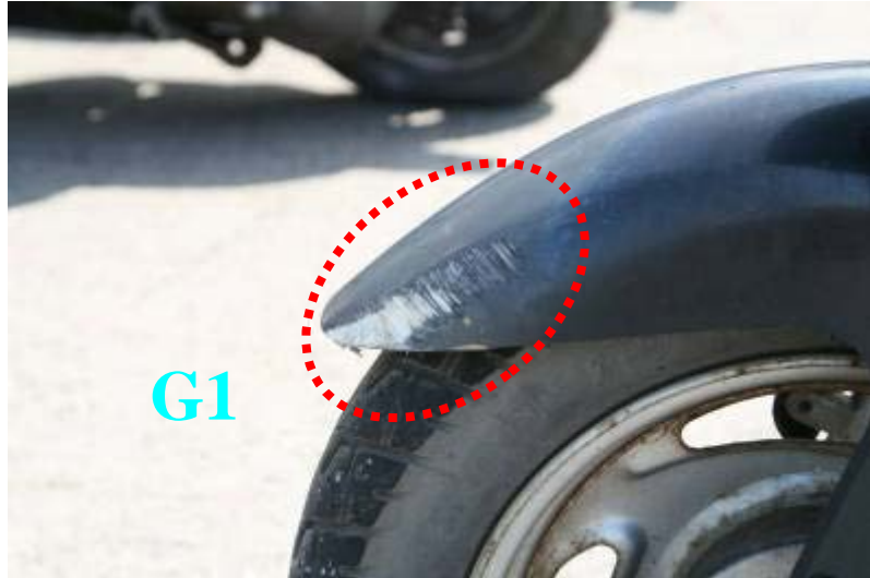
照片 5.2-23b 車頭擦地痕情形(實驗 23)
