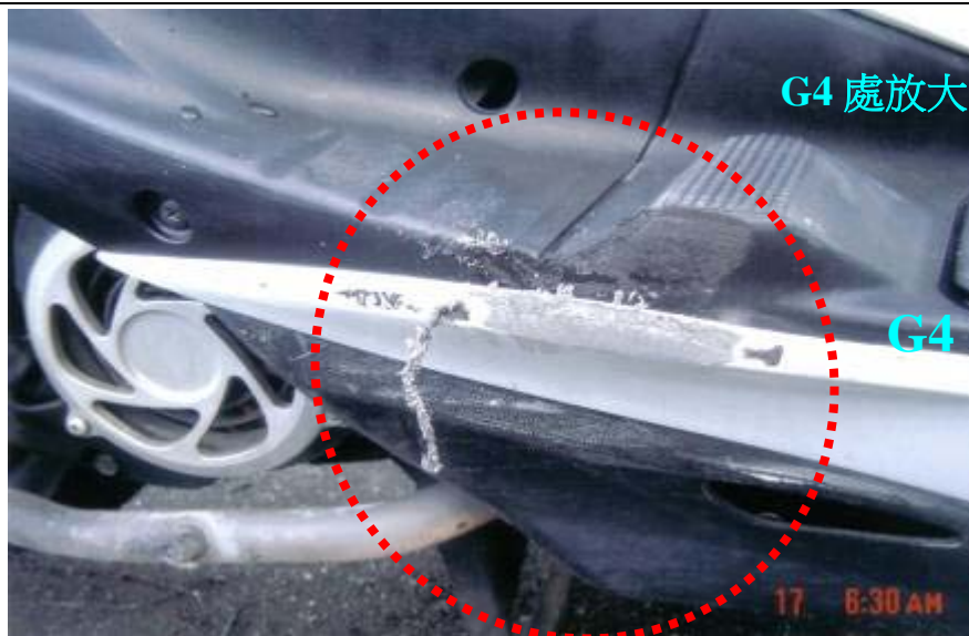
A 車右側側板腳踏處受損情形
