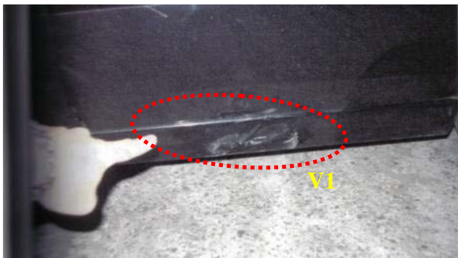
B 車左後車身受損情形
