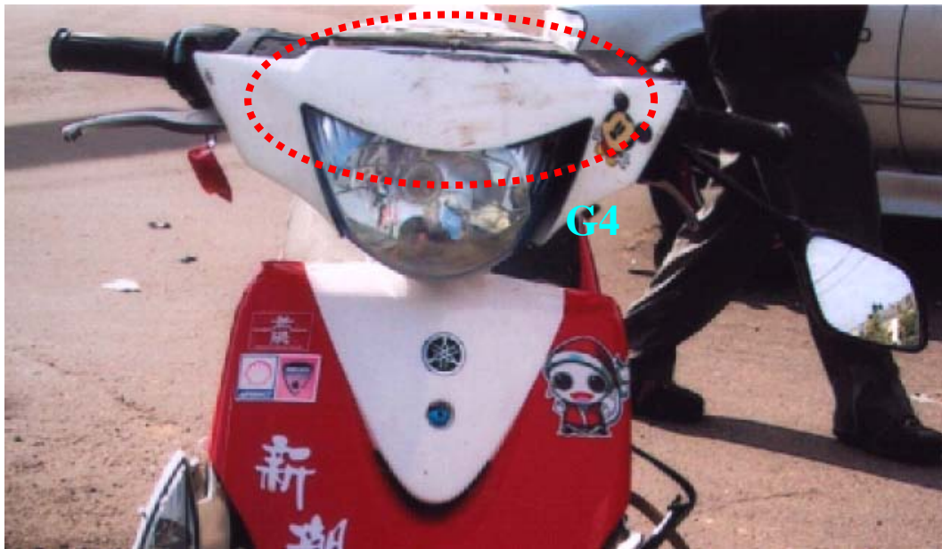
A 車前車頭受損情形
