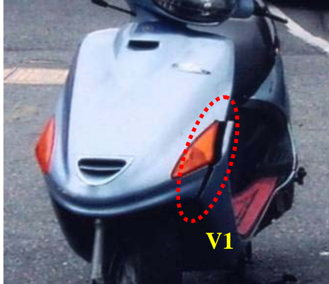
A 車左前護板破裂受損情形
