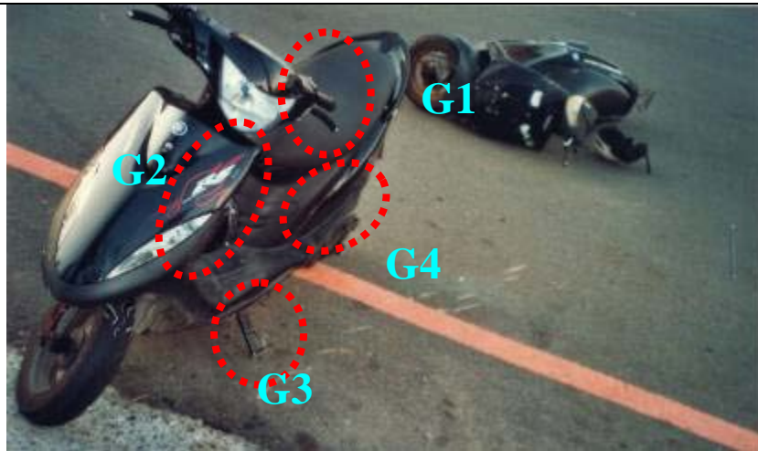
A 車左側車身受損情形
