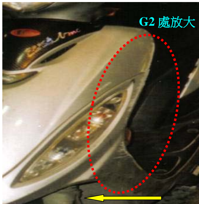
A 車右左前車頭受損情形
