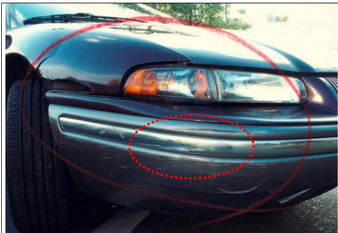
B 車右前外殼受損情形
