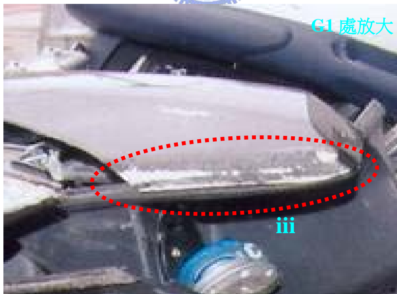
B 車左前護板刮損情形
