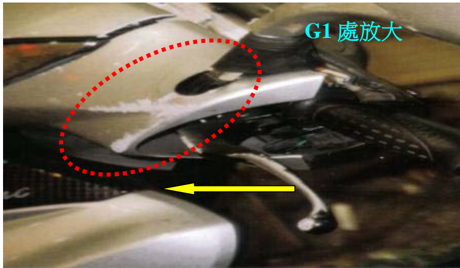
A 車右左前車頭受損情形
