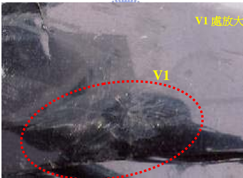
B 車右前護板刮損情形
