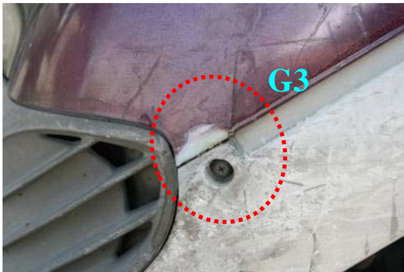
照片 5.2-21e 左後車身擦地痕情形(實驗 26)
