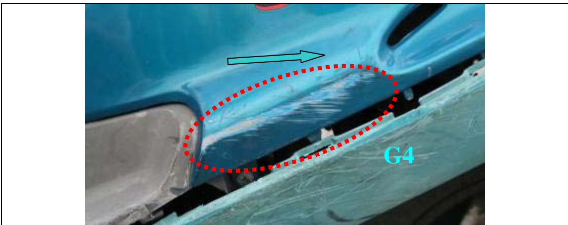
照片 5.2-8f 左後車身擦地痕情形(實驗 8)
