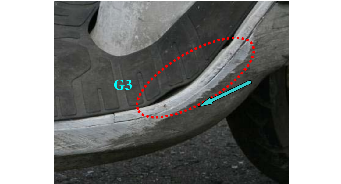
照片 5.2-1e 右側車身擦地痕情形(實驗 1)
