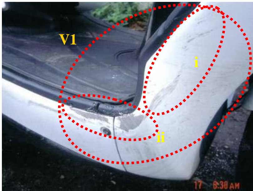
A 車右前護板刮損受損情形
