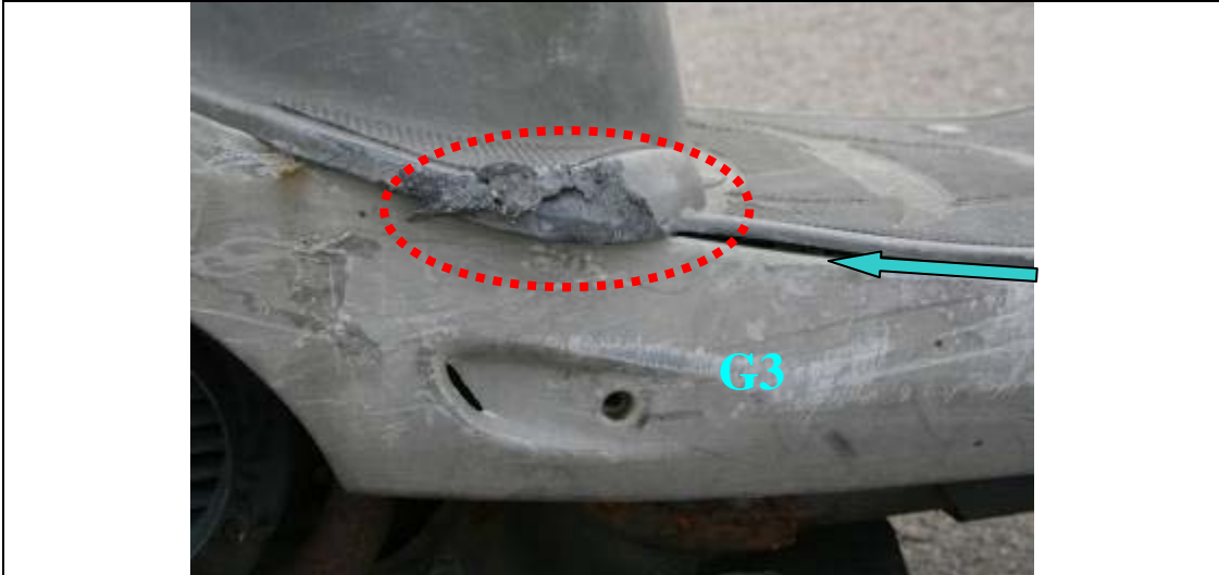
照片 5.2-3e 右側車身擦地痕情形(實驗 3)
