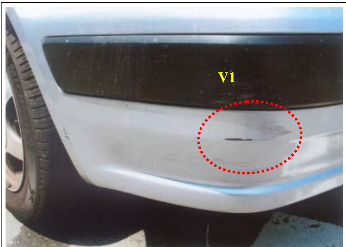
B 車右前保險桿受損情形
