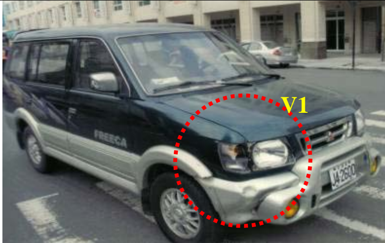
B 車右前車頭受損情形
