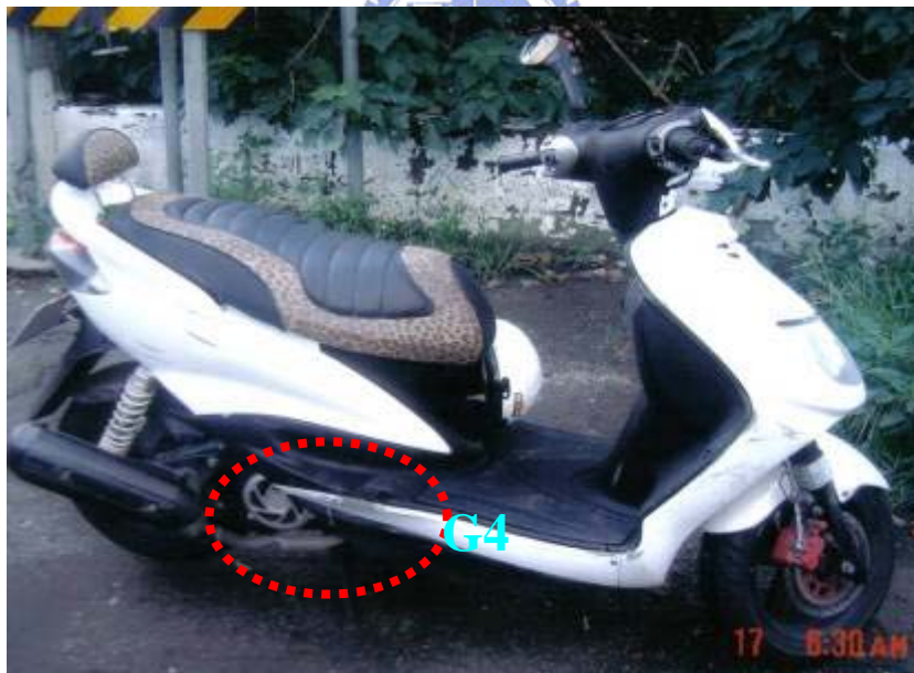
A 車右側車身受損情形
