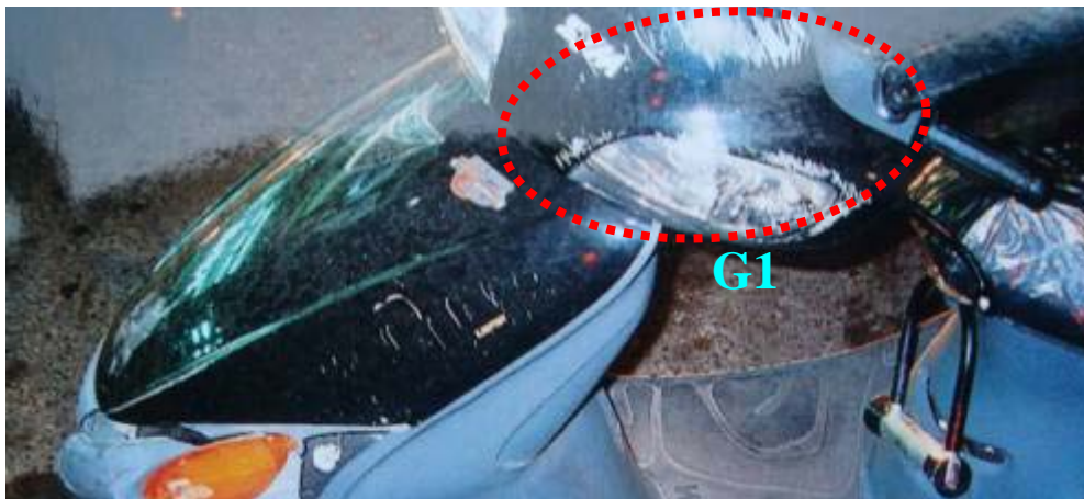
A 車左前車頭受損情形
