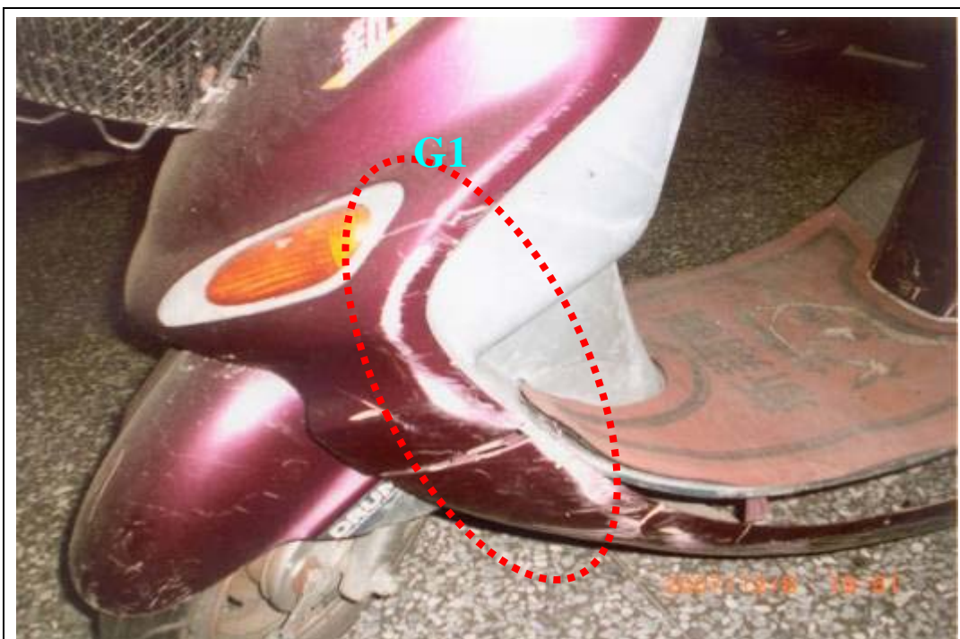
A 車左側車身受損情形
