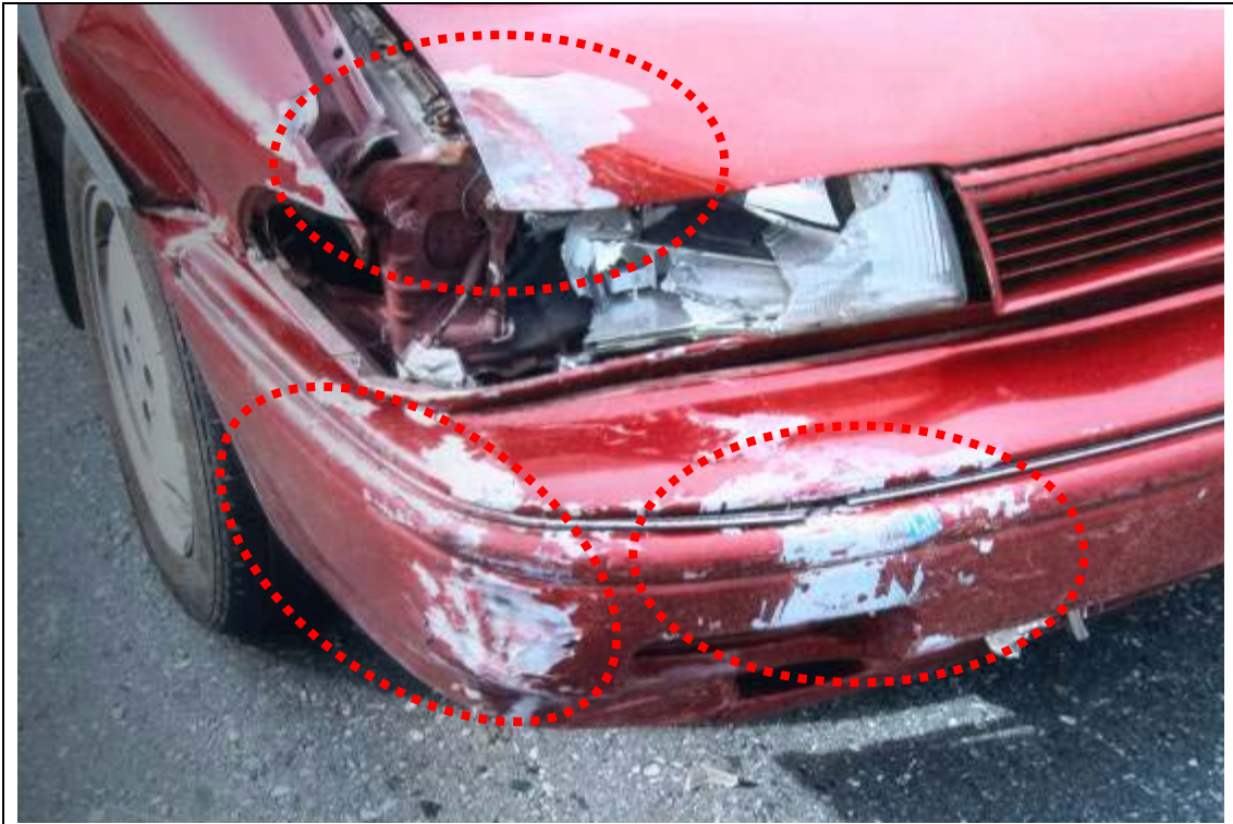
B 車右前外殼受損情形
