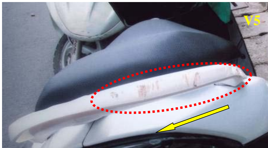
A 車右後車尾受損情形
