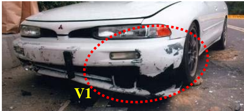
B 車左側保險桿受損情況情形
