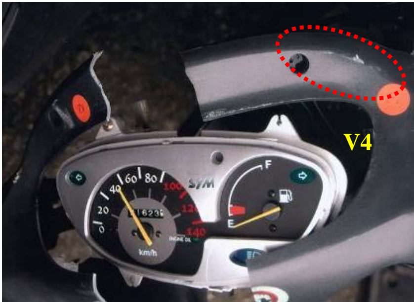
A 車儀表板受損情形
