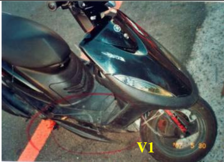
A 車右側車身受損情形
