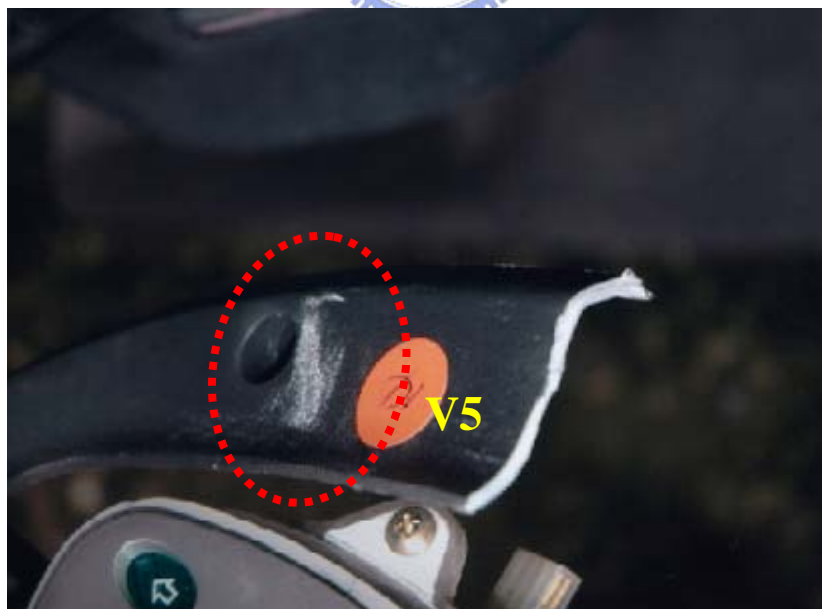
A 車儀表板放大圖受損情形
