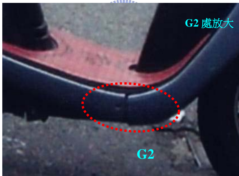
A 車右弧狀腳踏板外殼受損情形
