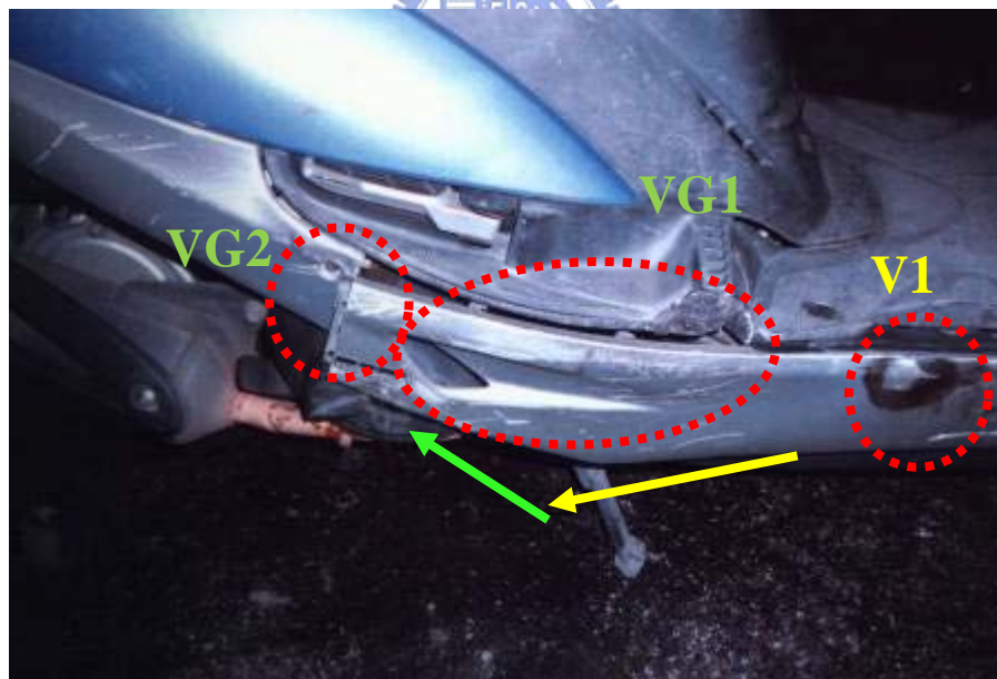
A 車車身受損情形
