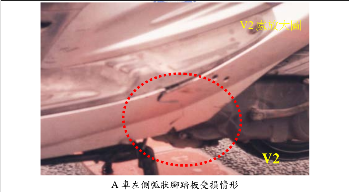
照片 4.3-11a-1 資料照片翻拍 A 車車身油漆刮痕 (案例十一)
