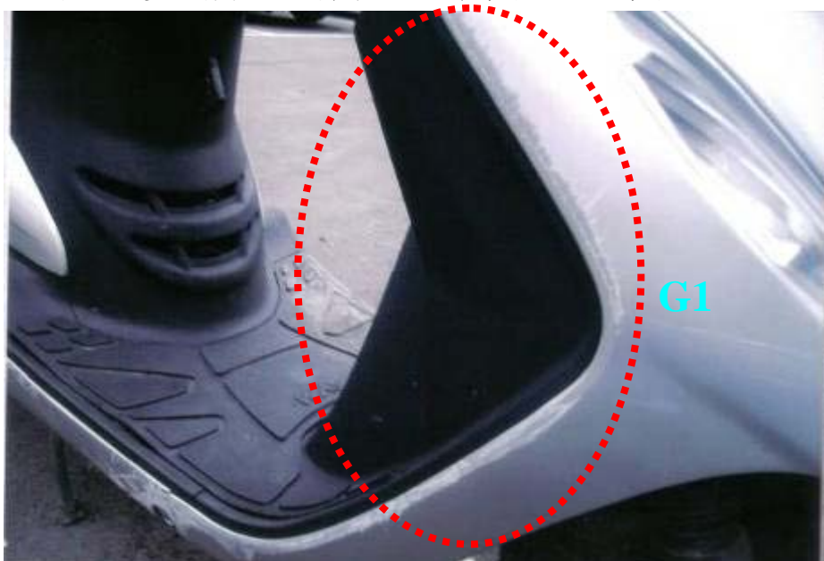
A 車右前護板受損情形
