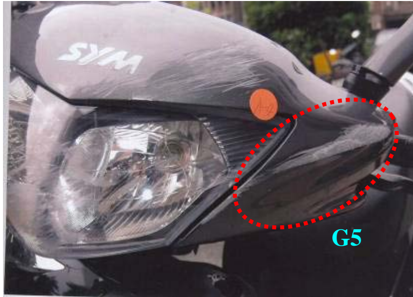
A 車左前車頭受損情形
