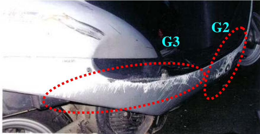
A 車右側護板與右後車身受損情形
