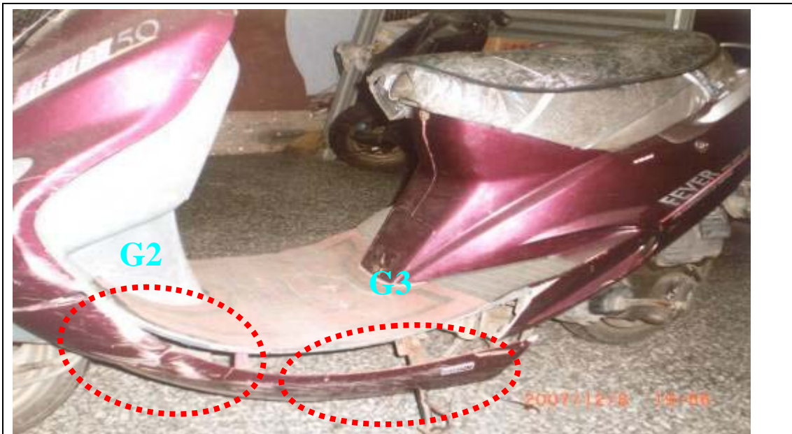
A 車左側車身受損情形
