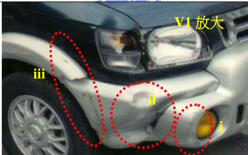
B 車右前車頭受損情形
