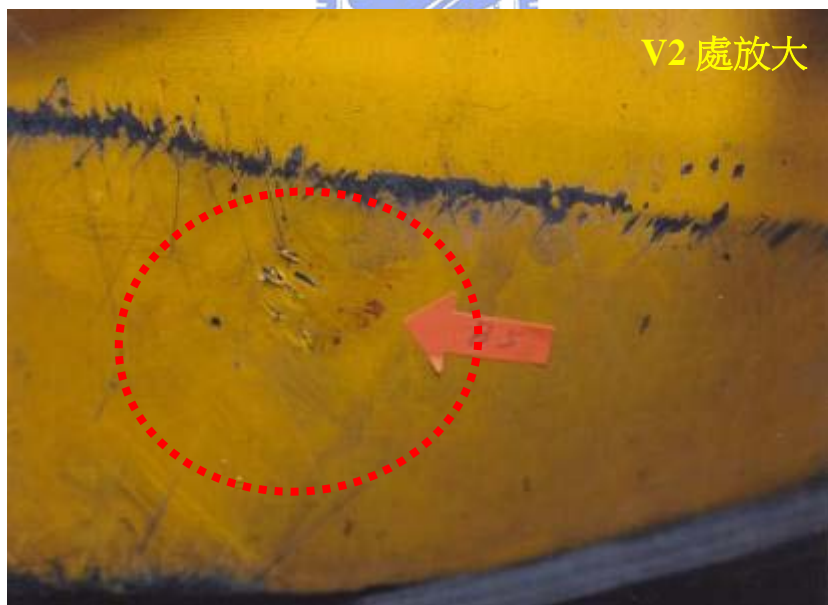
C 車車頭左側受損情形
