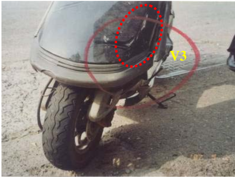
A 車左前護板受損情形
