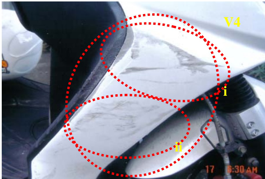
A 車右前護板受損情形
