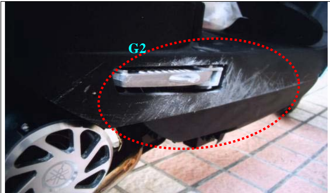
A 車右側車身受損情形
