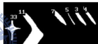
圖 3.4 (b) S-A Substrate 載板實體影像圖上的矩形區域放大圖。(編號 5 為製程上所產生的露金，非腳位)。
