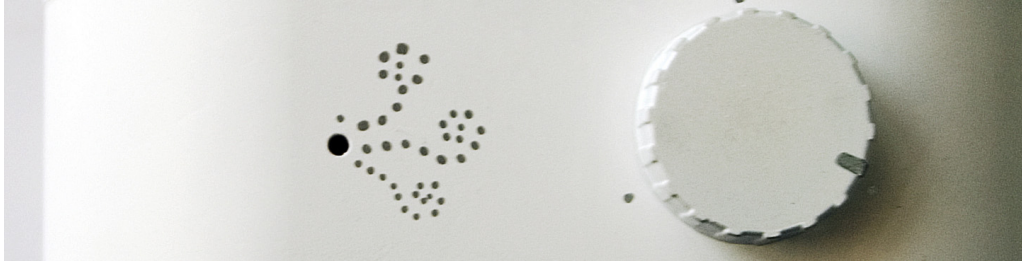
圖 4.2 調整工作模式的旋鈕，左方為散發香氛的小孔
