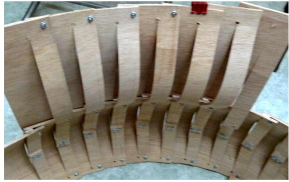
單向度彎曲單元構件經以易可彎板材為材料進行測試，及單元構件之預組裝過程，可知單元構件具構成自由形體之可能性。而檢視前述整體設計過程，可預見多項問題有待探討：
