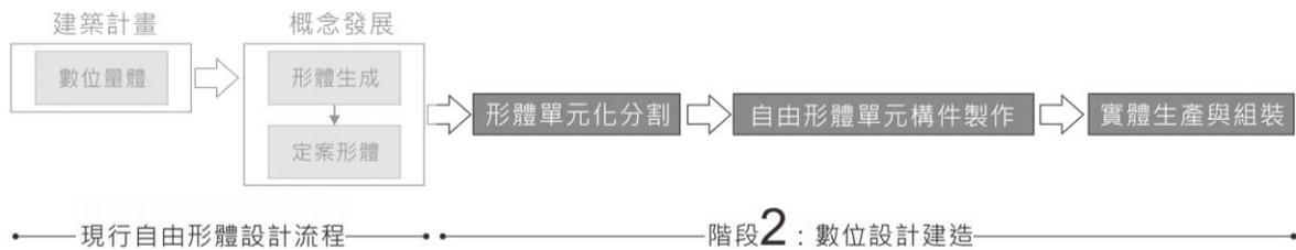
圖 4-1 預設外骨骼系統之自由形體初步設計與製造流程
