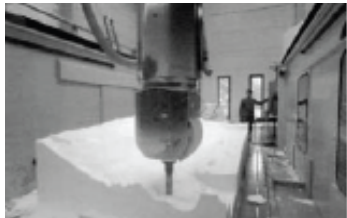
圖 2-11 CNC milling 切銷不同曲率鋼筋混凝土模版(Kolarevic, 2003)
