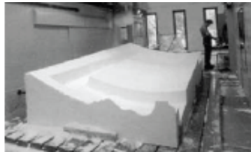
圖 2-11 CNC milling 切銷不同曲率鋼筋混凝土模版(Kolarevic, 2003)
