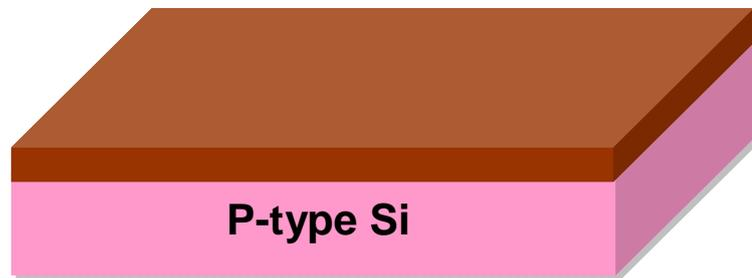
圖 3-2、水平爐管長 Dry oxide 5 nm。
