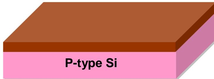
圖 3-10、水平爐管長 Dry oxide 2.5 nm。
