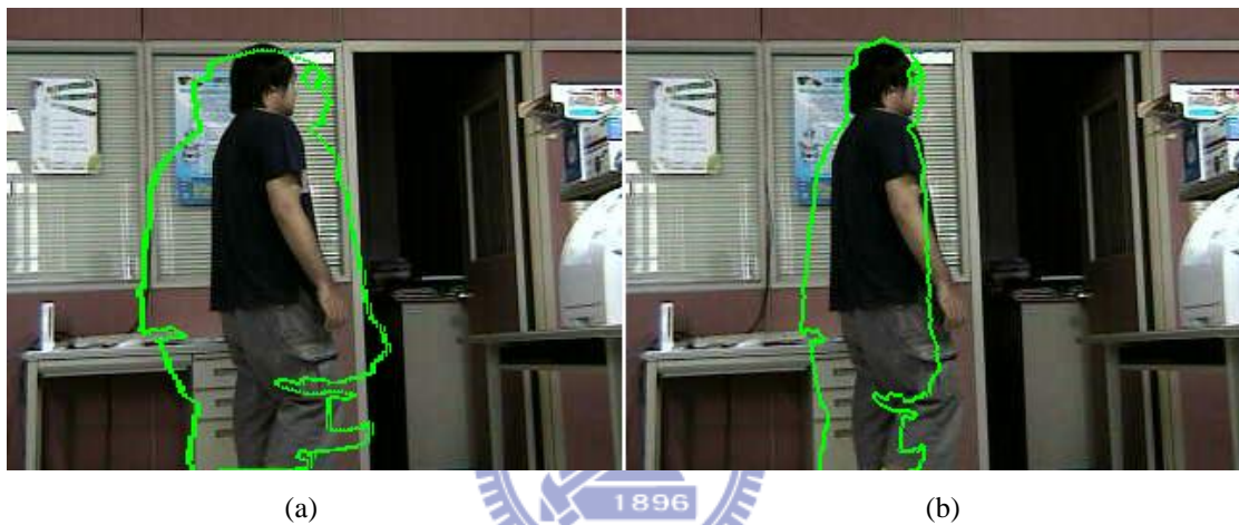
圖 3-24. 因雜點影響的轉換結果，(a)將雜點當作目標物的座標轉換結果， (b)沿用前一張影像的座標轉換。
