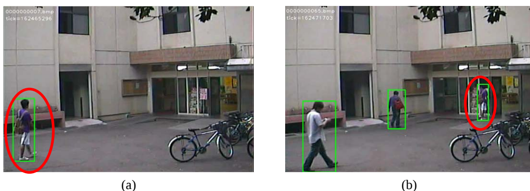
圖 4.9 畫面深淺處的尺寸差異：(a)前景物體於畫面淺處，(b)前景物體於畫面深處。
