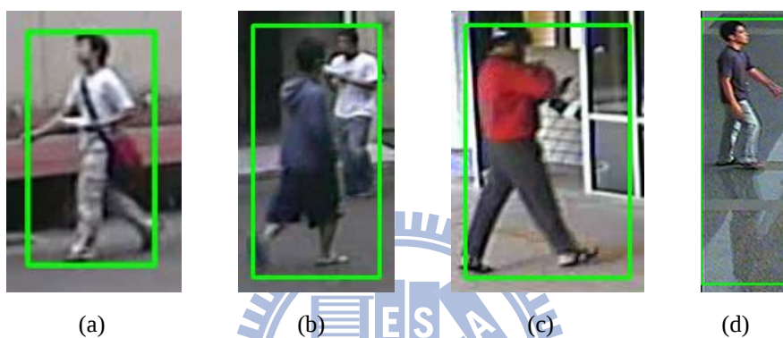
圖 4.7 外接矩形尺寸改變之實例：(a)行人手腳擺動，(b)行人發生交會，(c)前景物體陰影，(d)地面倒影。
