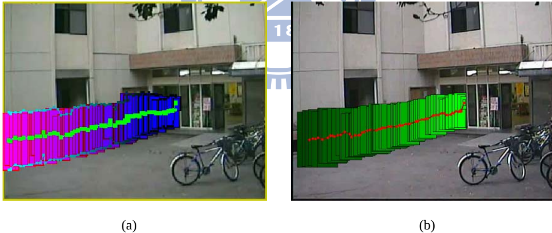
圖 4.1 單純移動模式下有無使用顏色直方圖之軌跡結果：(a)有使用顏色直方圖追蹤，(b)沒有使用顏色直方圖追蹤。
