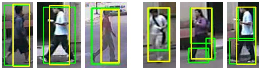
圖 6.1 手腳擺動和所偵測的前景不完整之尺寸改變的分析調整結果。
