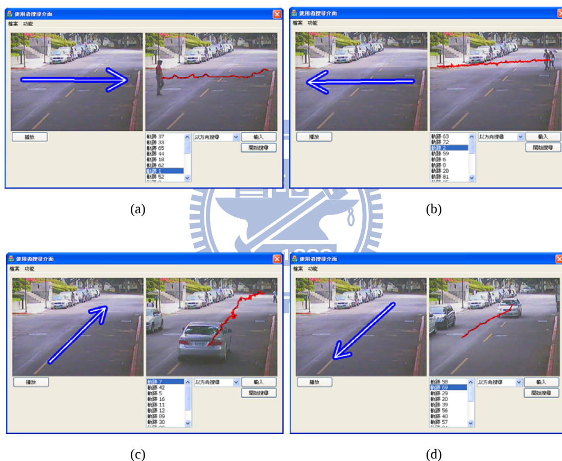
圖 6.9 以方向搜尋之結果：(a)搜尋向畫面右邊移動的前景物體，(b)搜尋向畫面左邊移動的前景物體，(c)搜尋向畫面上方移動的前景物體，(d)搜尋向畫面下方移動的前景物體。
