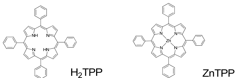
圖 4-1 H 2 TPP 及 ZnTPP 的結構圖
