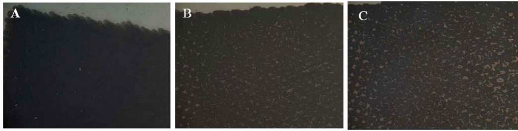
圖 3-22 不同 \text{TiCl}_4 後處理造成薄膜和 FTO 玻璃連結變差之 OM 圖
