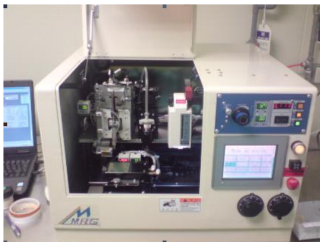
圖 11 自動植錫球設備 (本研究整理)
