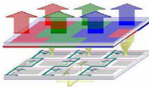
圖 2-3 不同強度驅動紅、綠、藍三個次像素以構成一個像素【33】
