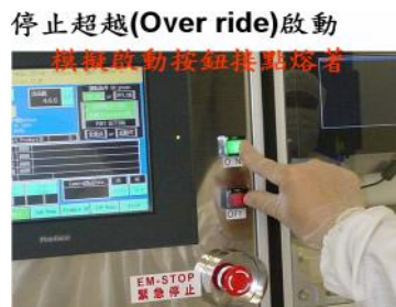
圖4-2 模擬啟動按鈕接點熔著情境，按下停止按鈕機台應停止【17】
