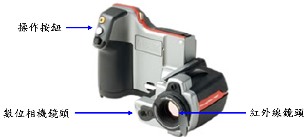
圖 3.1 紅外線熱影像儀正面外觀
