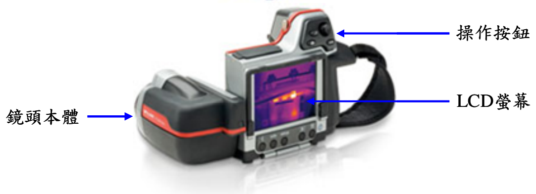
圖 3.2 紅外線熱影像儀背面外觀
