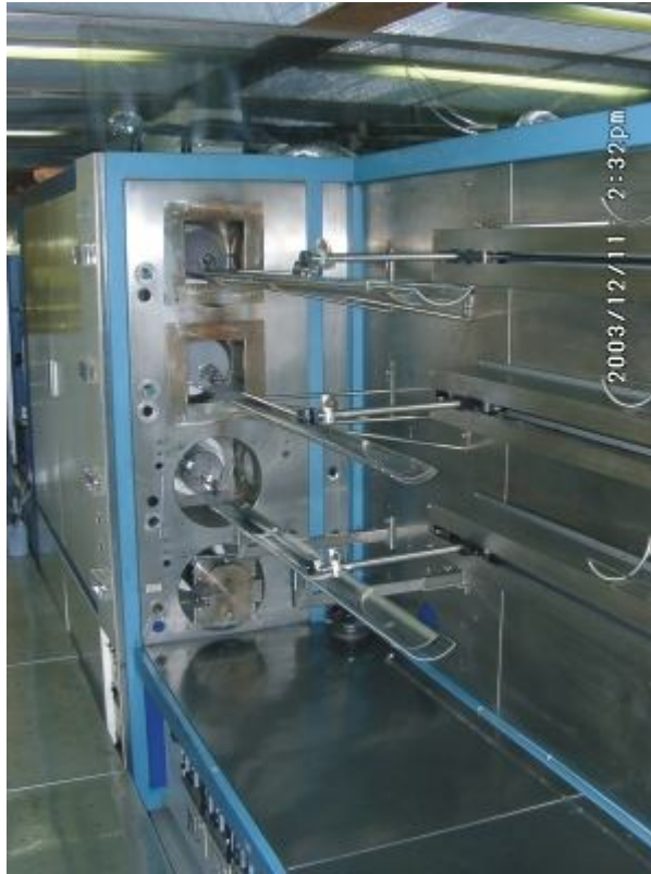
圖 3.2.1 高溫爐管設備
