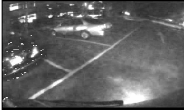
圖 4.22 Sobel 運算後大於 35 的像素位置示意圖(夜間)
