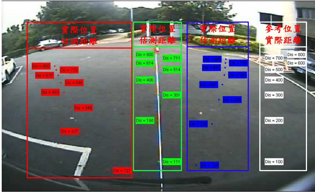
圖 6.1 方程式一之距離估測實驗結果
