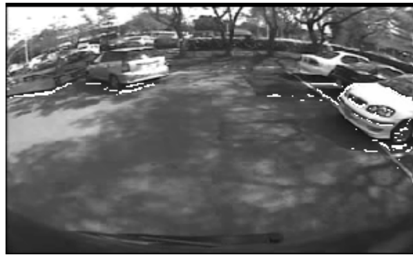
圖 4.20 Sobel 運算後大於 50 的像素位置示意圖(日間)
