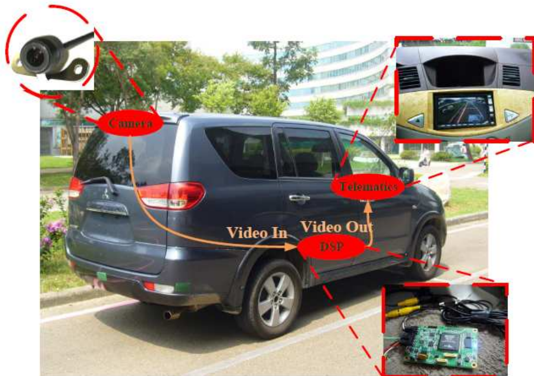
圖 9 硬體(DSP-Board)實車測試結果圖
