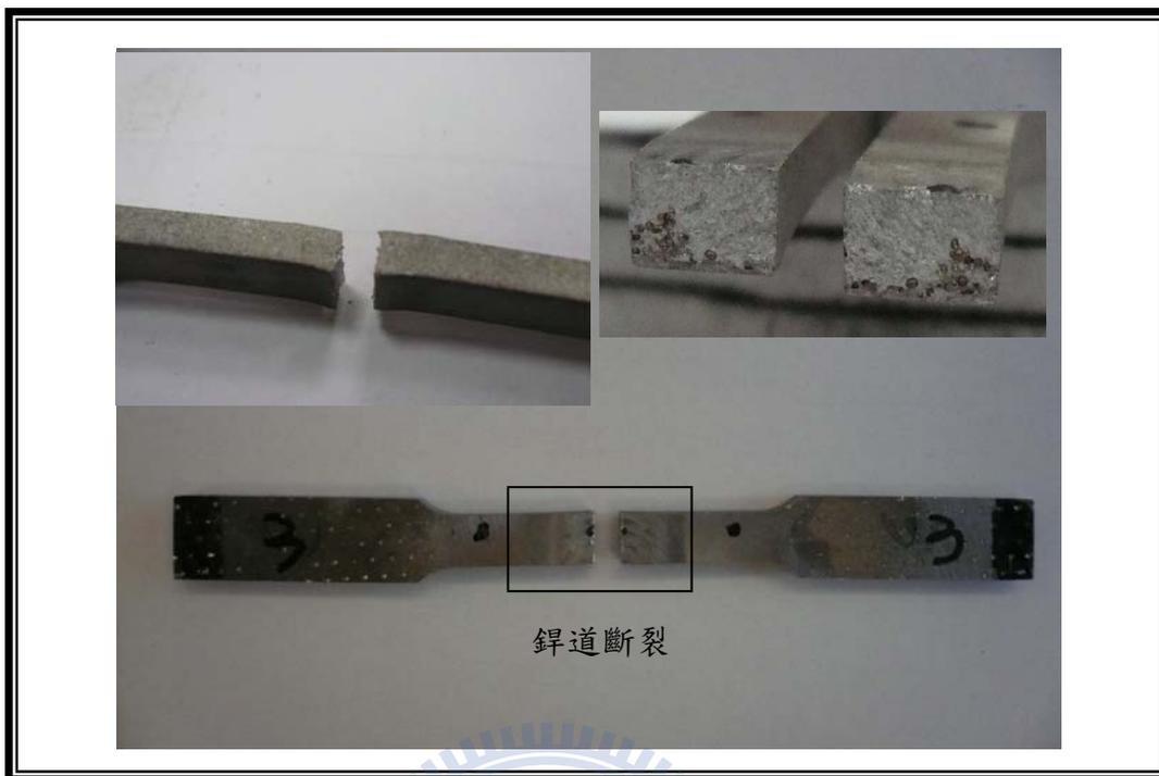
圖 4-29 無填料銲件之銲後熱處理拉伸試片結果
