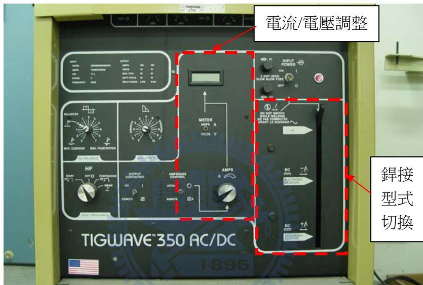
圖 3-3 銲接設備調整控制單元
