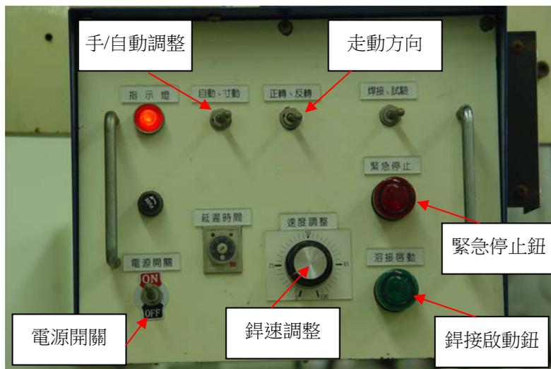
圖 3-4 自走台車操作控制
