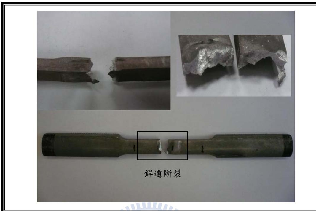
圖 4-25 有填料銲件之銲後熱處理拉伸試片結果
