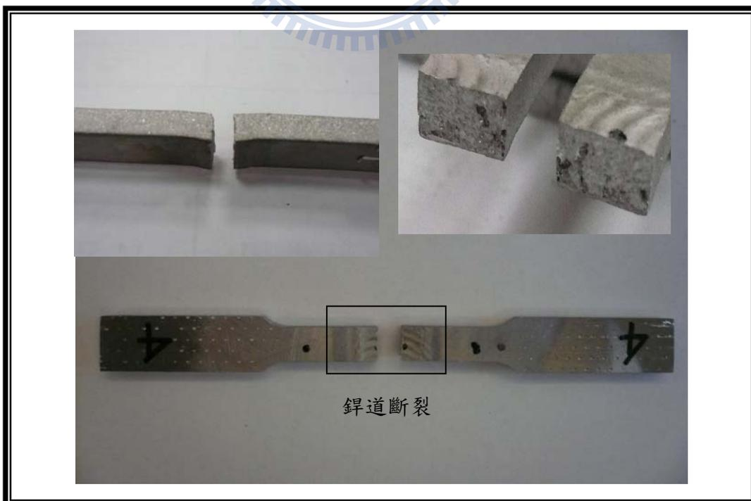
圖 4-30 無填料銲件之銲後無熱處理拉伸試片結果
