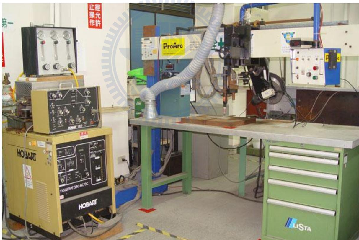
圖 3-5 HOBART TIGWAVE 350 氬銲機與 ProArc 數位控制銲接台車
