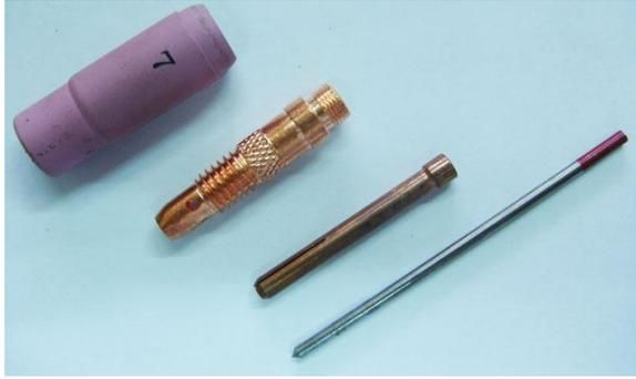
圖 3-6 鎢棒、夾頭、夾頭套及瓷杯
