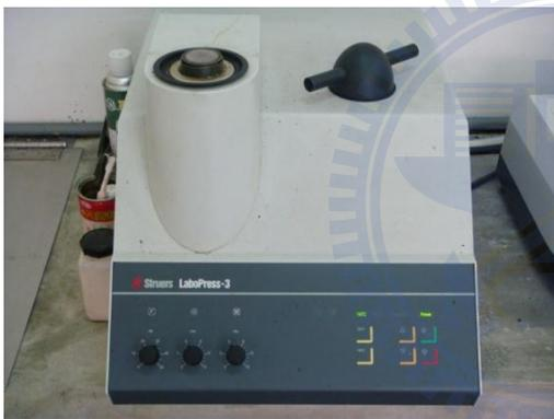
圖 3-9 熱鑲埋機 Struers LaboPress-3
