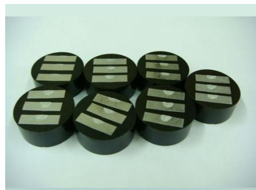
圖 3-12 腐蝕後試片
