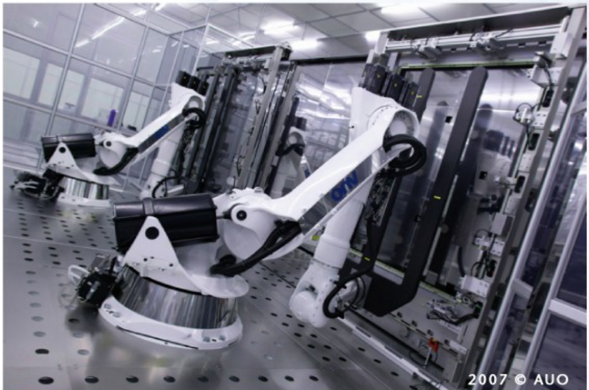
圖 1-3 Cell Assembly 製程環境為 Class 10 等級 [18]
