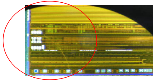
圖 5.32 矽晶片破裂處
