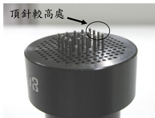
圖 4.7 整列頂針較高處示意圖
