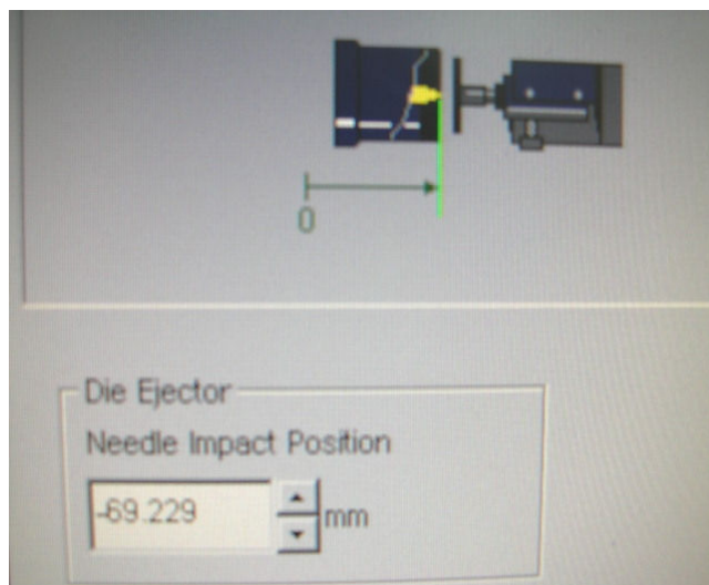
圖 5.17 頂出高度校正示意圖
