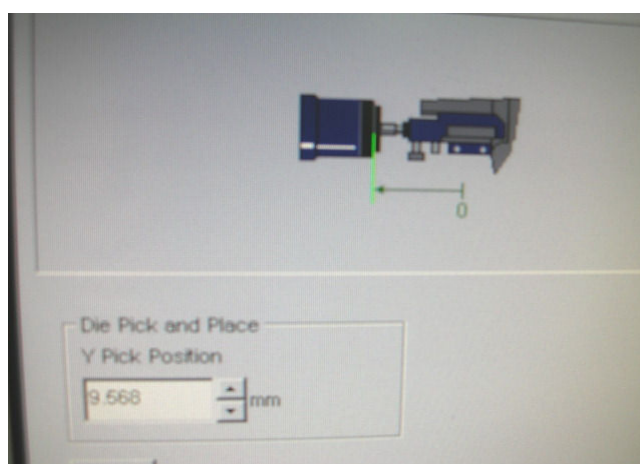
圖 5.18 吸取高度校正示意圖
