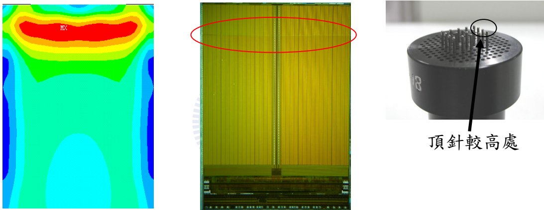
圖 5.36 案例 3 應力集中造成矽晶片破裂(未依比例劃出)
