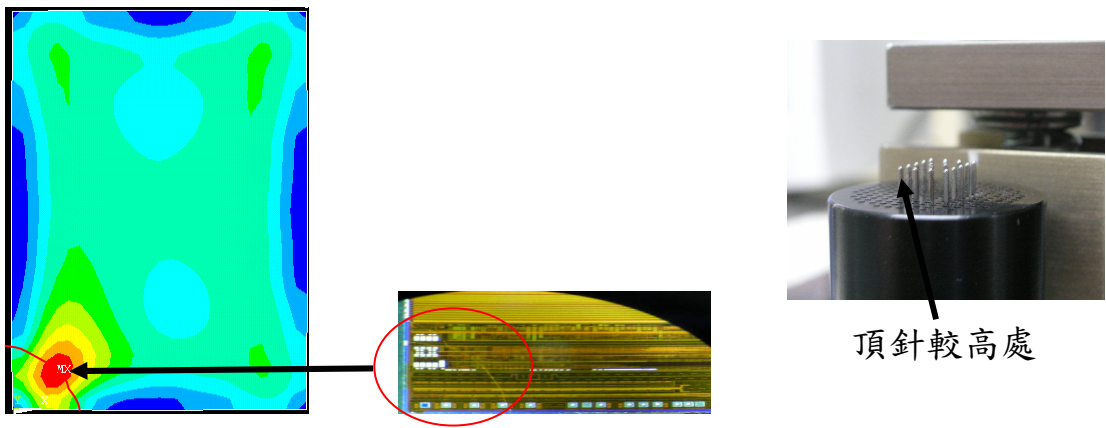
圖 5.35 案例 2 頂針高度異常產生破裂(未依比例劃出)
