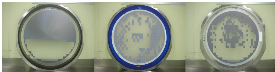
圖 5.22 A、B、C 三種切割膠帶貼附於矽晶圓上(由左至右)
