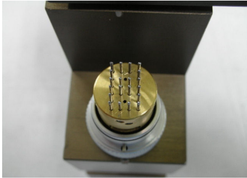
圖 5.10 頂針裝設完成
