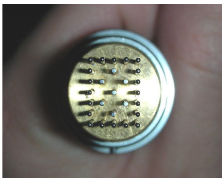
圖 5.38 黏晶機 6.8x9.6mm-27 根針頂針機構組俯視圖
