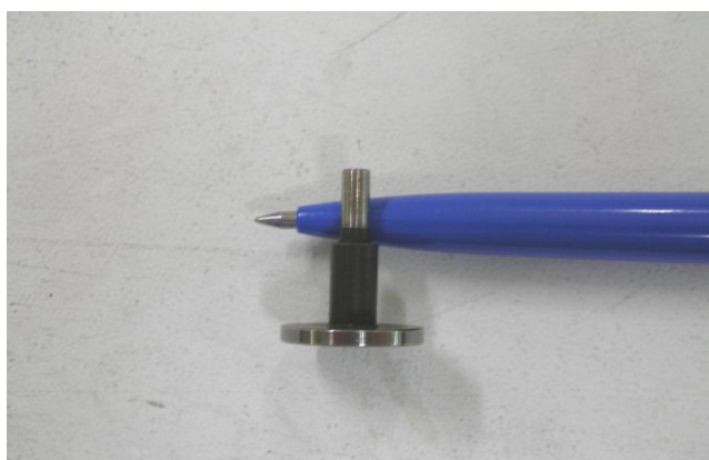
圖 5.16 高度校正治具
