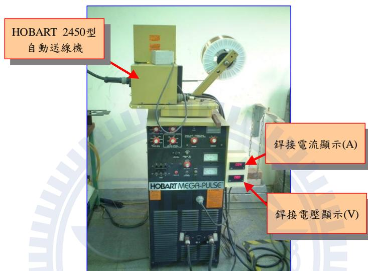
圖 3-4 HOBART MEGA-PULSE MPI-350 MIG 銲接機
