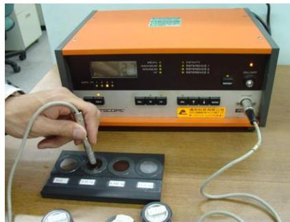
圖 3-7 Ferritscope M10B-FE 型肥粒相測定儀
