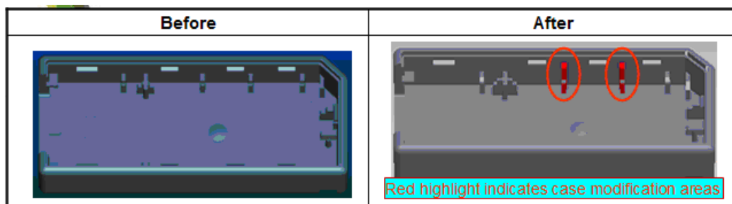
圖 4-25 增加成品 Rib 結構設計變更前後比較圖
