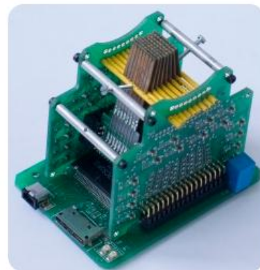
圖 14 Laterotactile 公司 之壓電觸覺迴授裝置(STRESS)
