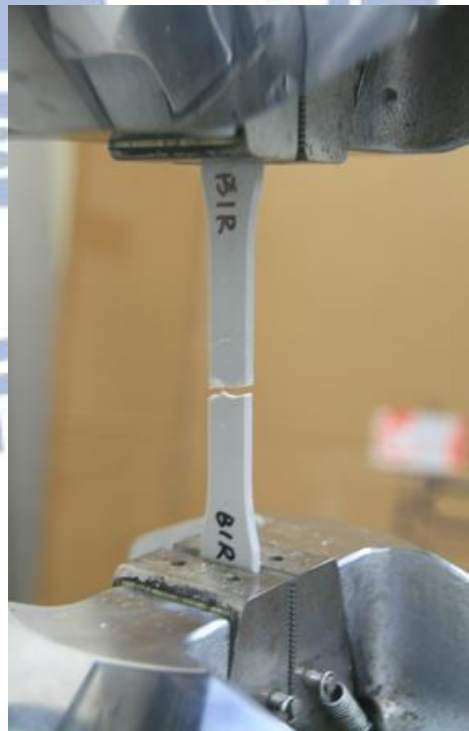
圖 5-10 試片拉伸完成及斷裂點位置
