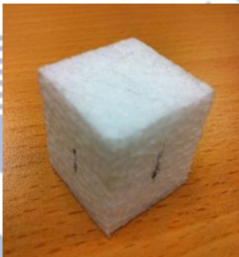
圖 4.2 EPP 發泡聚丙烯樣品
