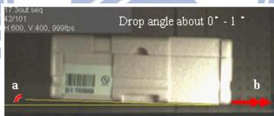
圖 4.13 撞擊接觸面角度
