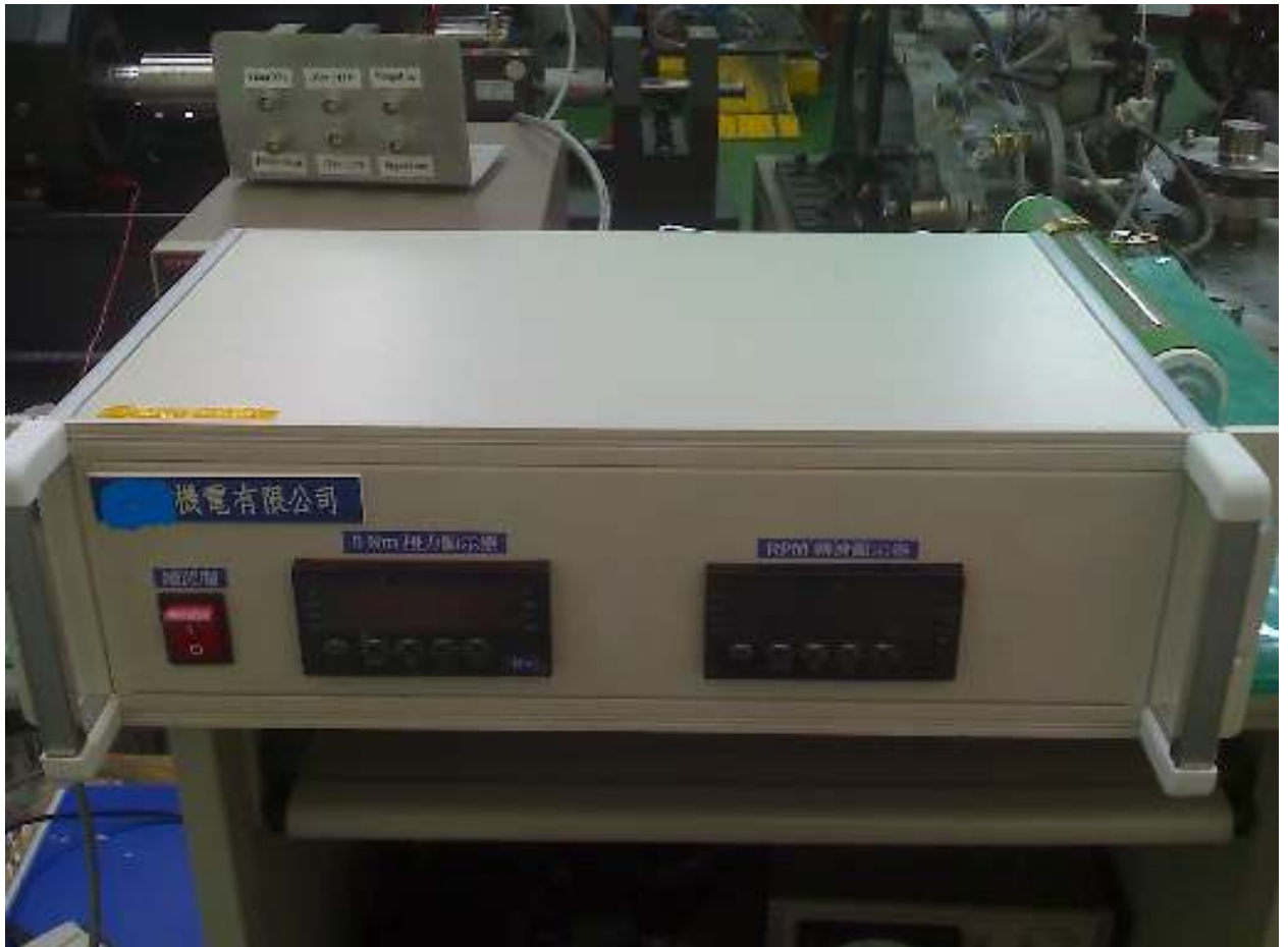
圖18 扭力與轉速顯示系統
