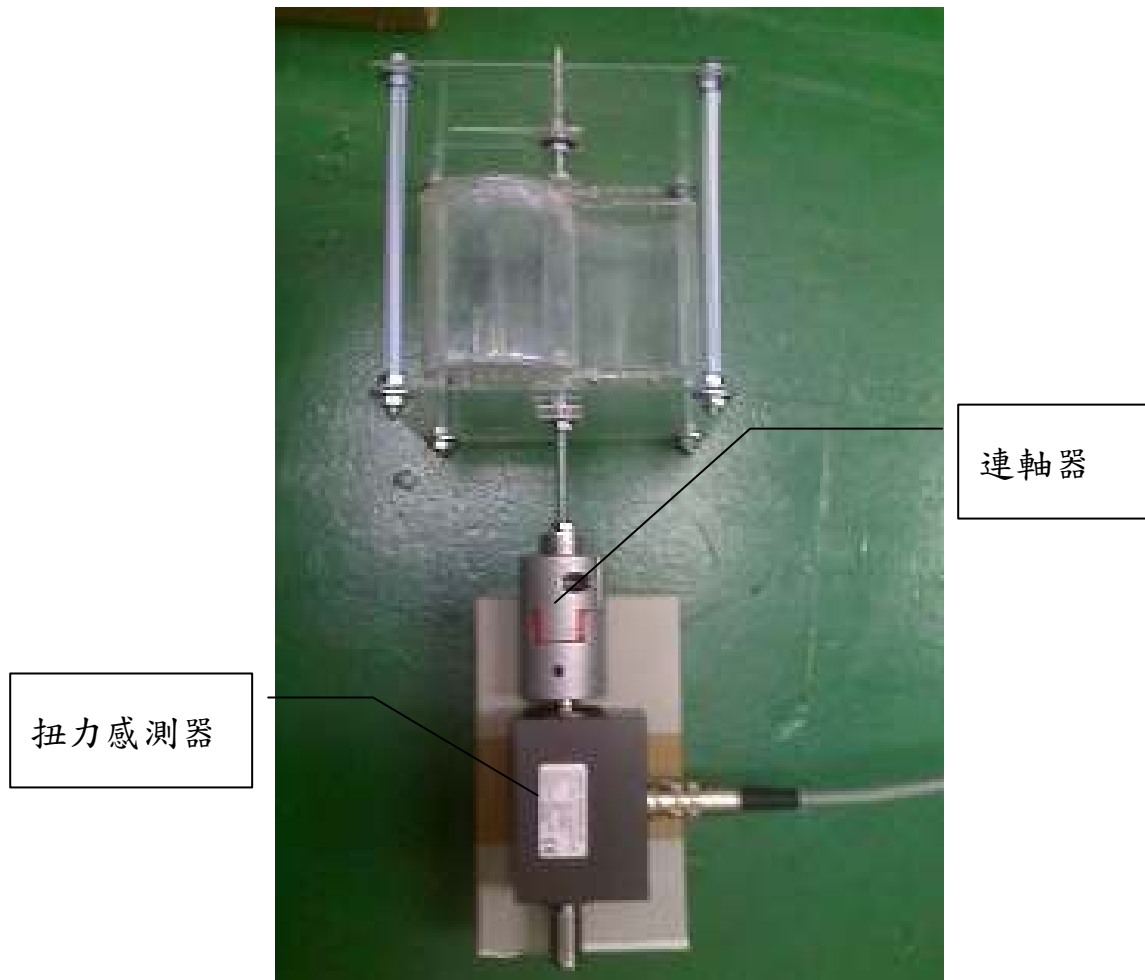
圖25 實驗風車完成品與扭力感測器配置
