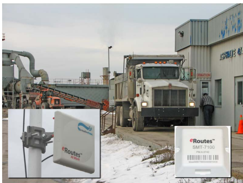
圖 21. 利用 RFID 進行工地進出管制
