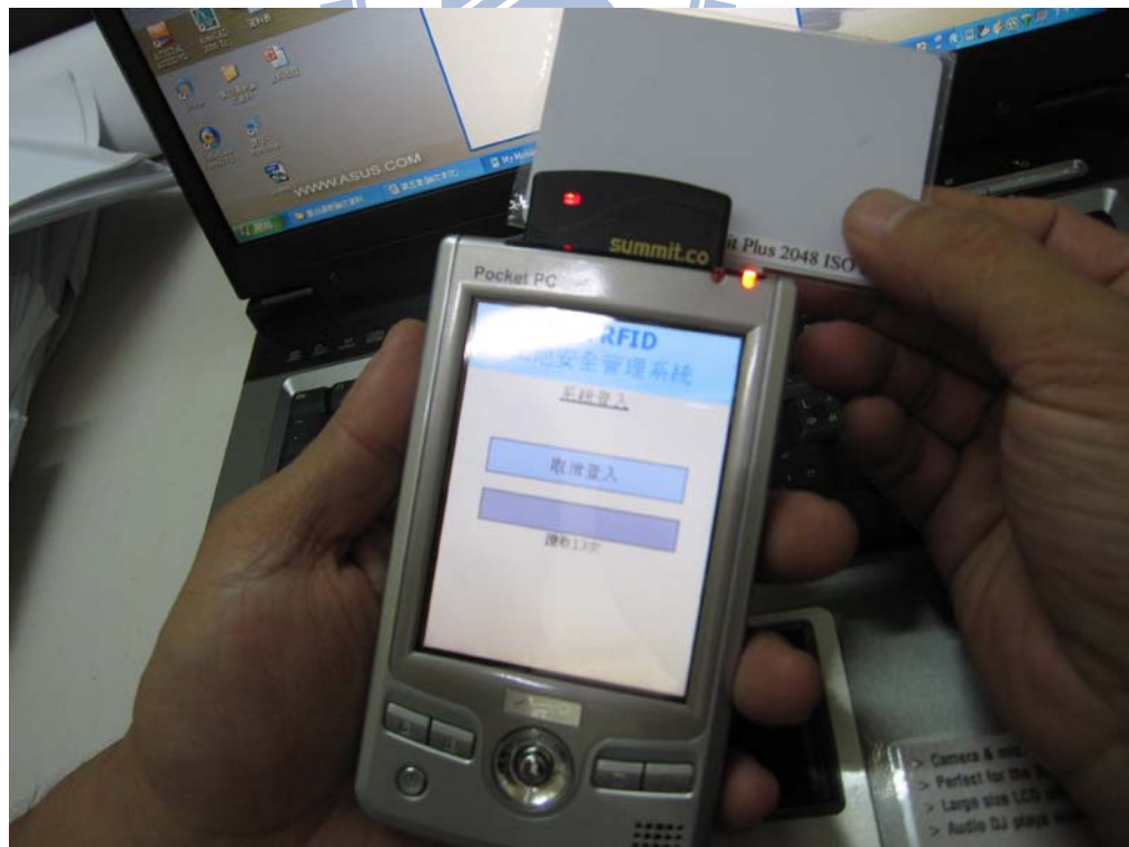
圖 5-34 使用者持識別證登入 RFID 系統測試
