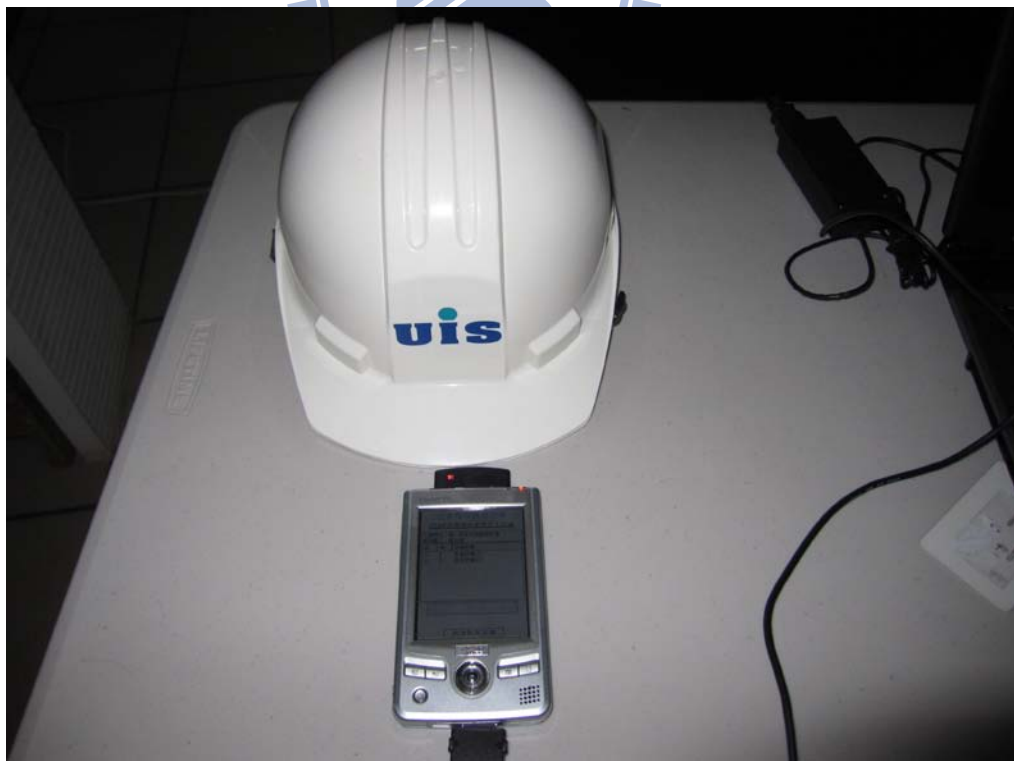
圖 5-36 人員安全防護器具讀取測試(1)
