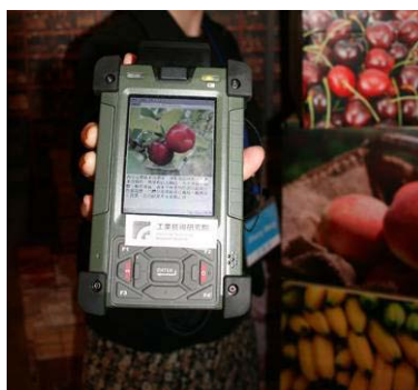
圖 2-8 內嵌式讀取器的 PDA 行動裝置
