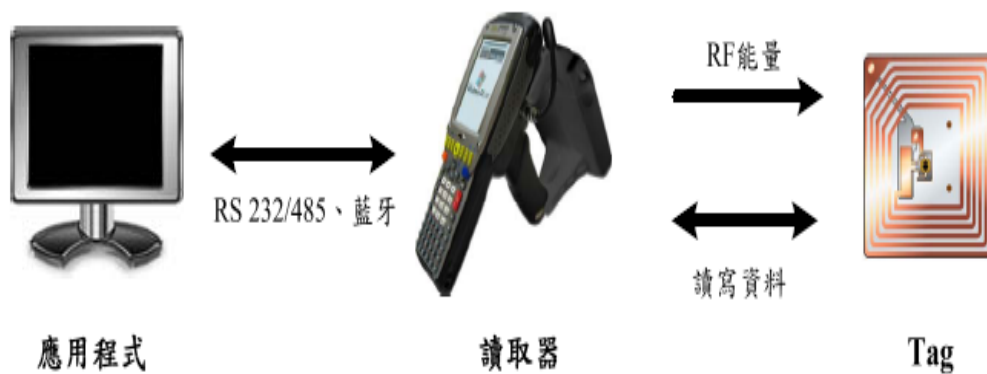
圖 2 RFID 系統操作示意圖(參考文獻 16)
