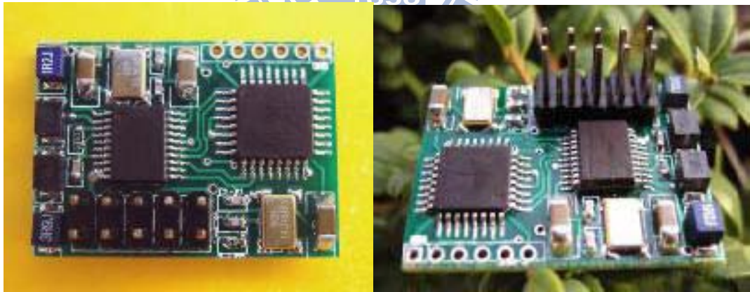
A4 RFID CF介面電子標籤讀寫卡印刷電路板
