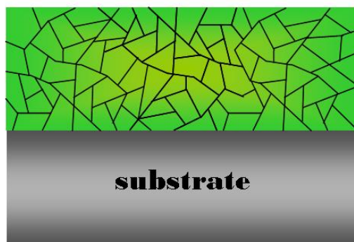
圖 1.6 所示之完全熔融區域晶粒成長示意圖。
