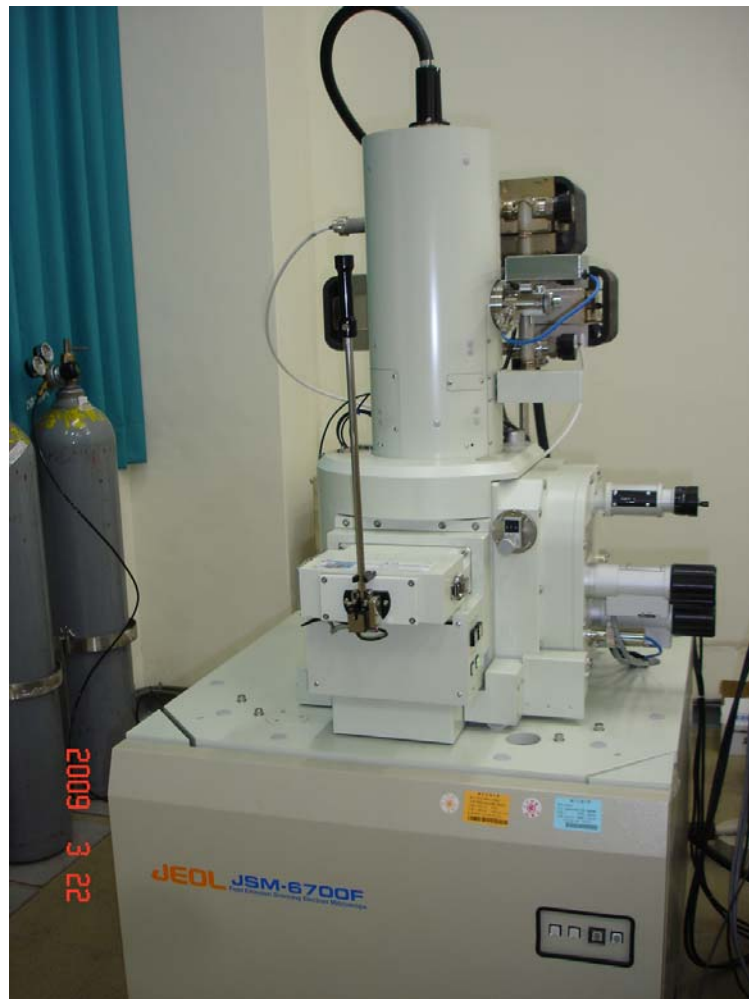
圖 2.5 JEOL JSM6700F SEM 儀器。
