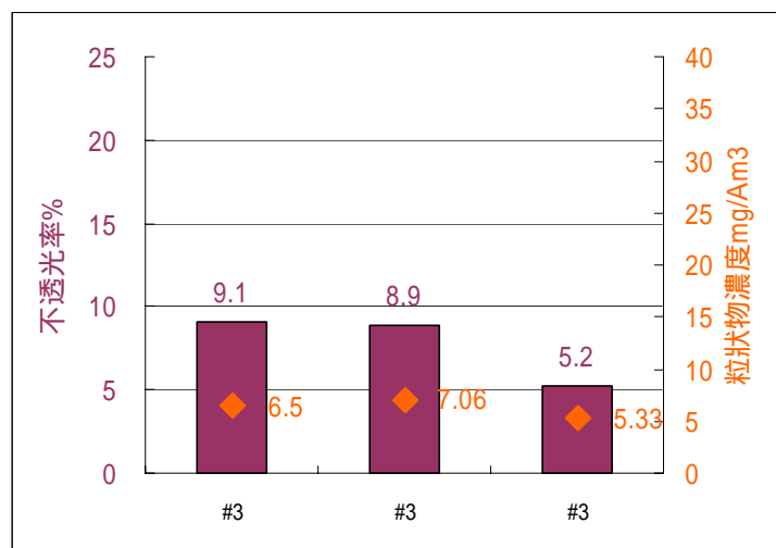
圖 4.7、研究對象僅安裝 ESP 下不透光率評估值與粒狀物濃度之關係
