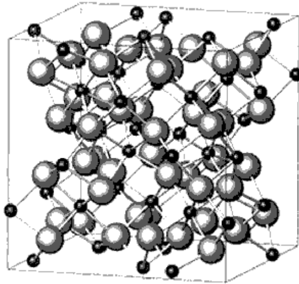
圖 2.15 氧化錫晶體結構圖
