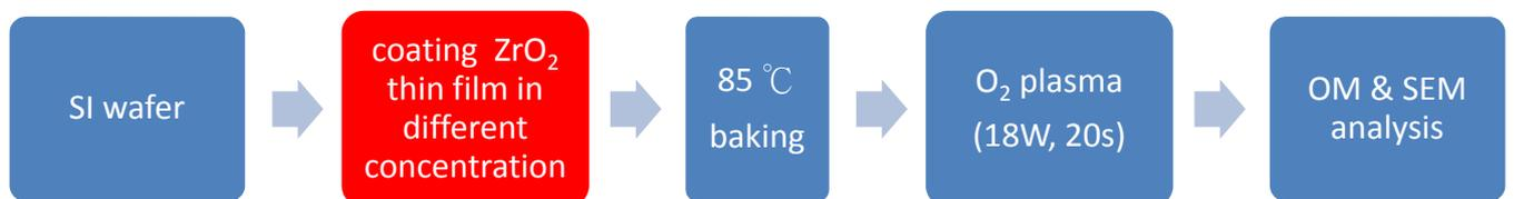
圖 28：OM&SEM 觀察 ZrO<sub>2</sub> 薄膜之實驗步驟
