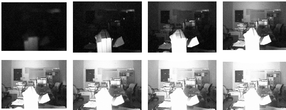
圖4-2 掃描式紅外線打光器，每個週期都能產生各種曝光條件的影像。
