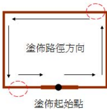
圖 3.7 框膠塗佈不穩現象及相關位置示意圖（逆時針方向塗佈）
