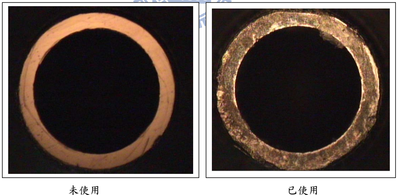
圖 4.4 針頭-鎳製噴嘴尖端。外徑 0.45mm，內徑 0.35mm。
