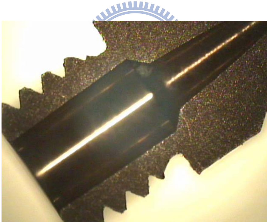
圖 2.22 一體成型之針頭(nozzle)剖視圖，此圖主要使用材質為鎳 Ni(Wt 99.8%)
