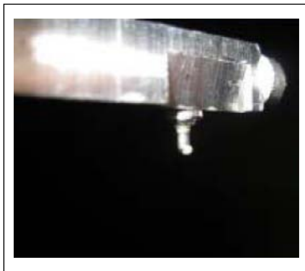
圖 4.6 針頭噴嘴針端側邊破損，框膠易從側邊流出。
